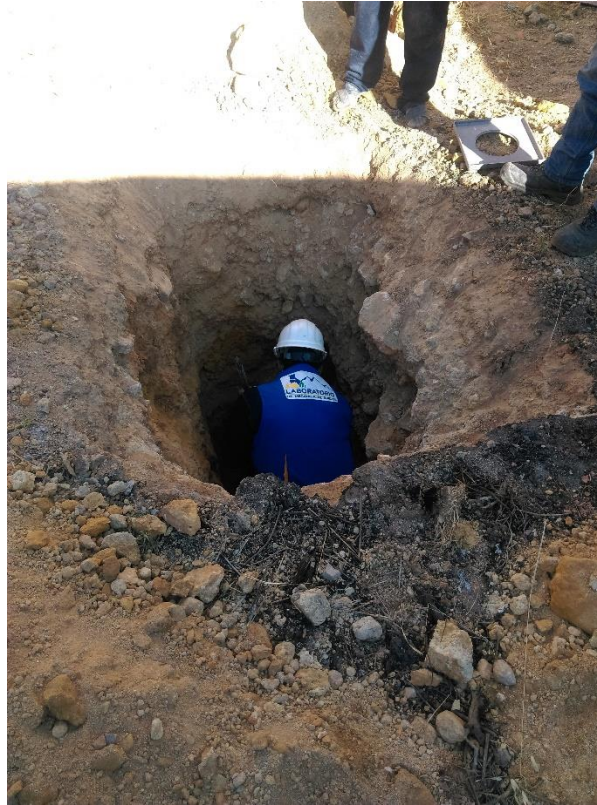
Figura 73. Toma de muestras in situ
