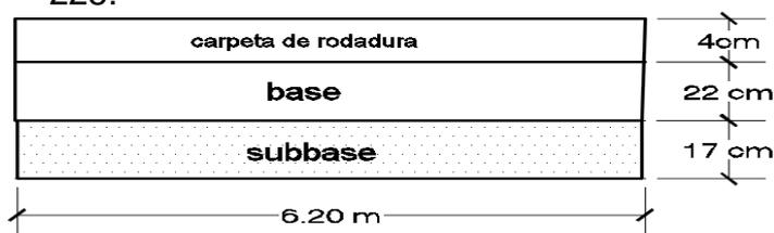
**Figura 3.2.** Espesor de capas existente en la estructura del pavimento, Km 1 + 500.
