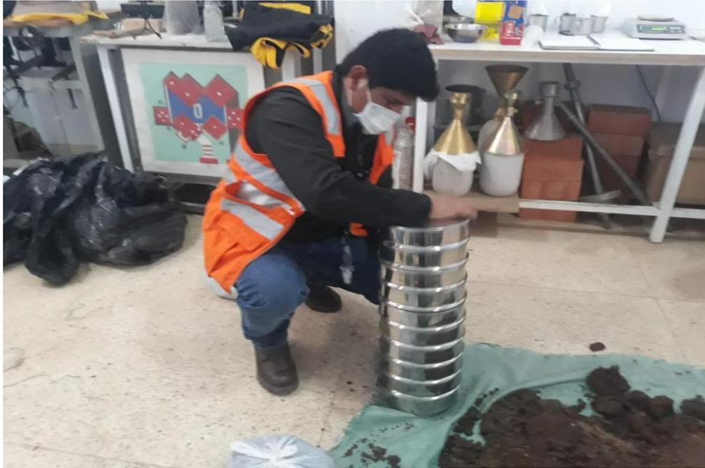
Figura N° 05: trabajos de laboratorio ensayo de granulometría.
