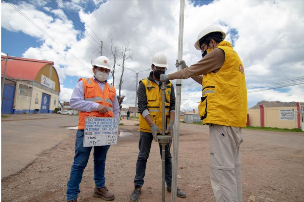
Figura N° 03: trabajos de campo ensayo CBR in situ equipo PDC.
