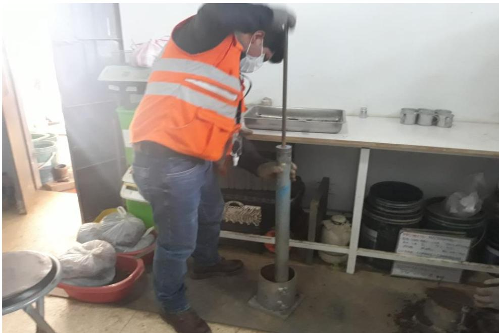
Figura N° 06: trabajos de laboratorio ensayo proctor modificado.
