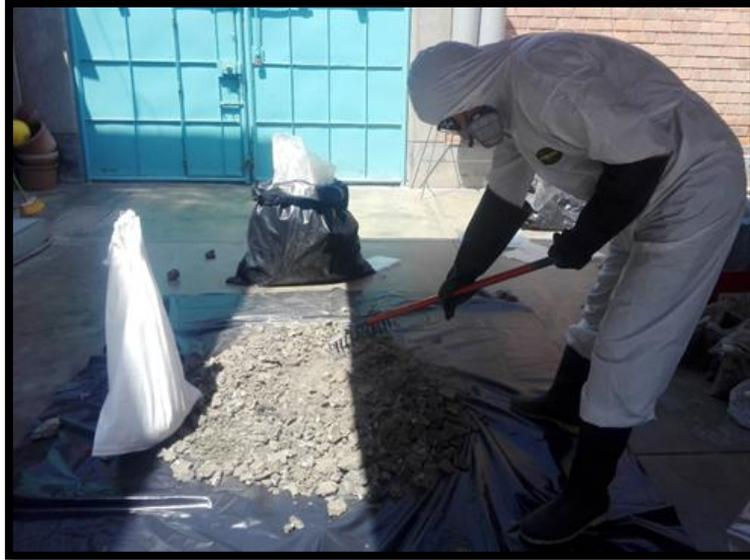
*Figura 12:* Homogeneización inicial del biosólido
