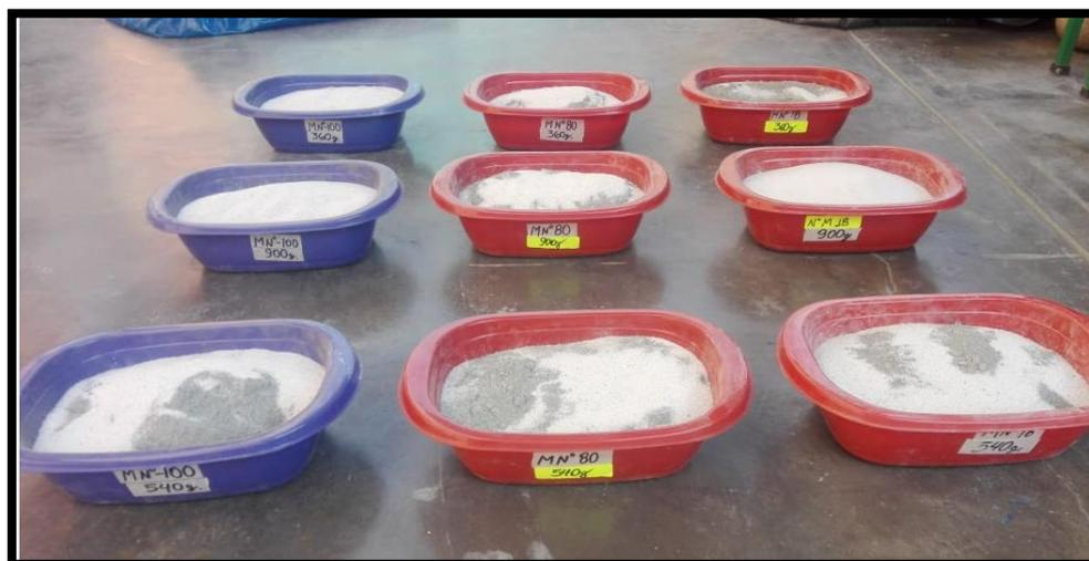
**Figura 46:** Dosificación completa para los ladrillos según granulometría y dosis de biosólido
