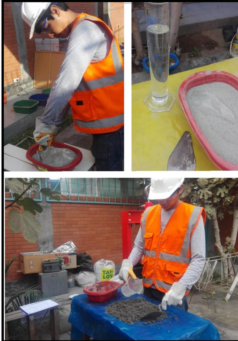
**Figura 47:** Preparación de mezcla inicial y dosis de agua
