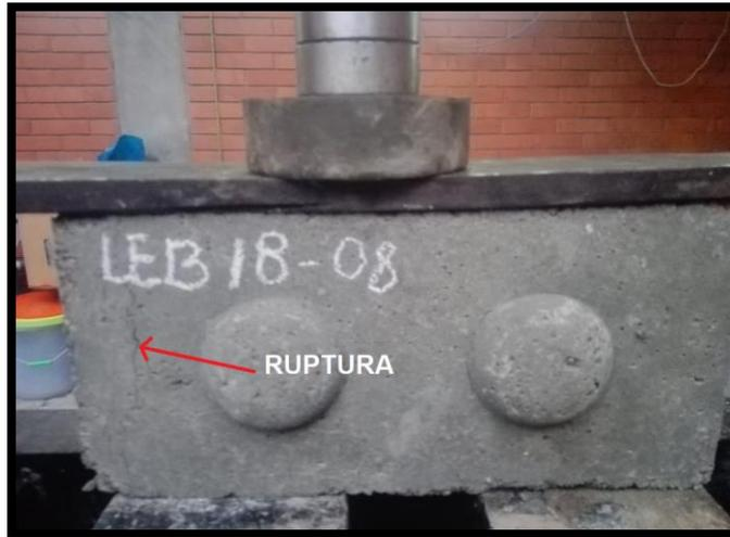
*Figura 65:* Punto de ruptura del LEB de malla N°18
