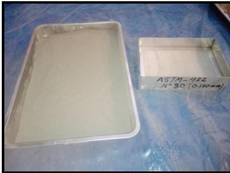
**Figura 19:** Biosólido tamizado a través de la malla N° 18
