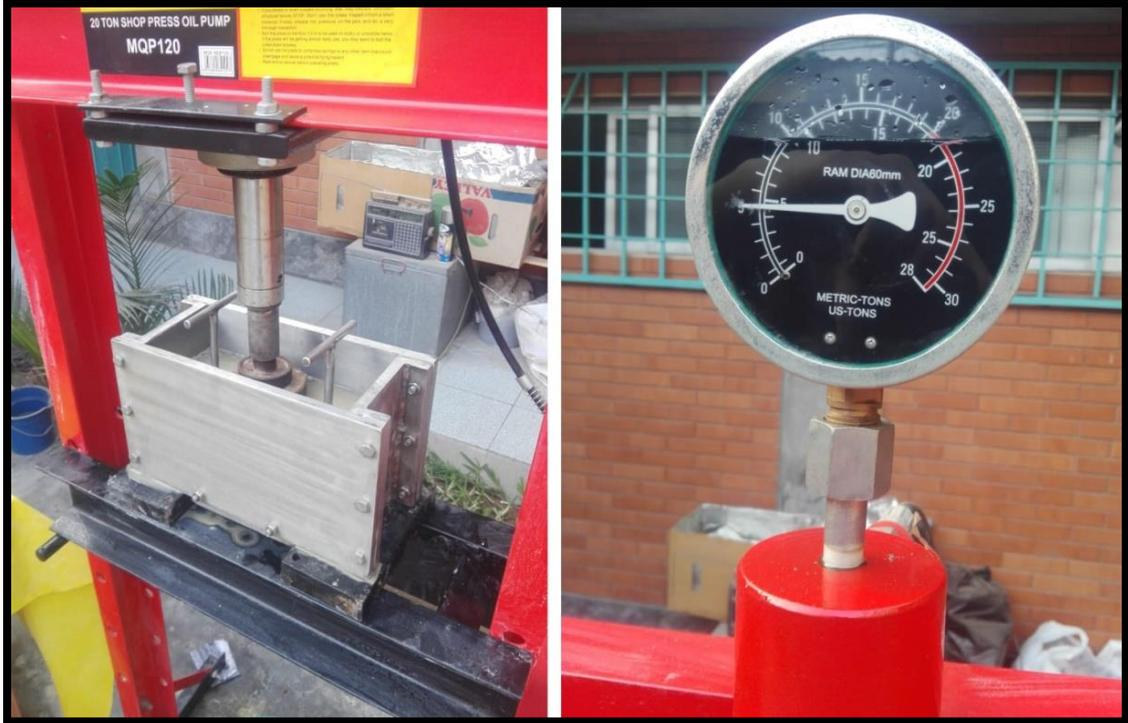
**Figura 49:** Prensado de la mezcla a 5Tn, para elaboración de ladrillo
