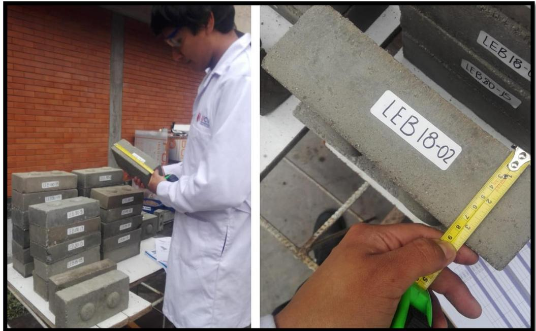
**Figura 56:** Medición dimensional del ladrillo ecológico
