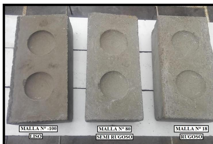
**Figura 62:** Acabo de ladrillos cara inferior
