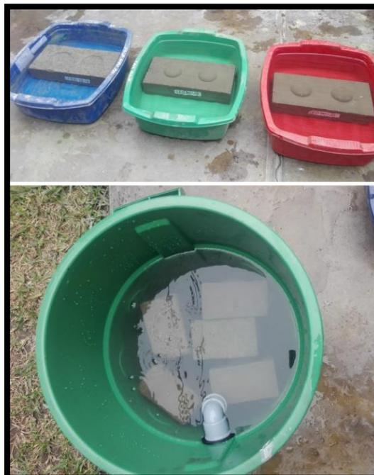
**Figura 61:** Proceso de sumergido de ladrillos
