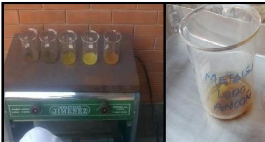
**Figura 28:** Preparación de solución de lodos con HNO<sub>3</sub> Y HCL
