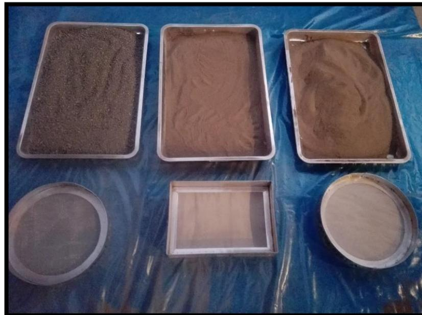
**Figura 21:** Resultado de las muestras en 3 tamices
