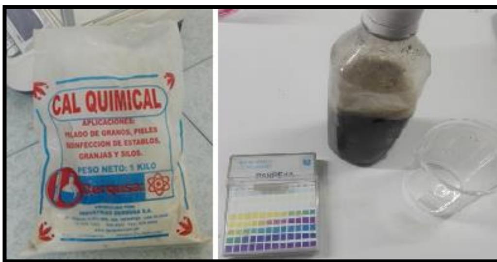
*Figura 37:* Estabilización del biosólido con Cal
