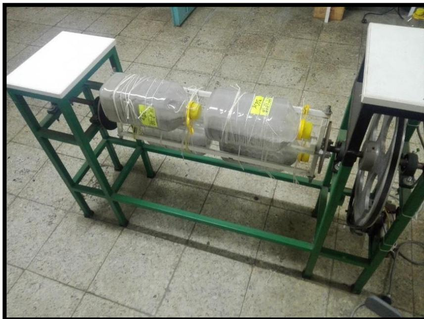
**Figura 45:** Tratamiento de lodos con Cal (CaO) a través de agitador eléctrico
