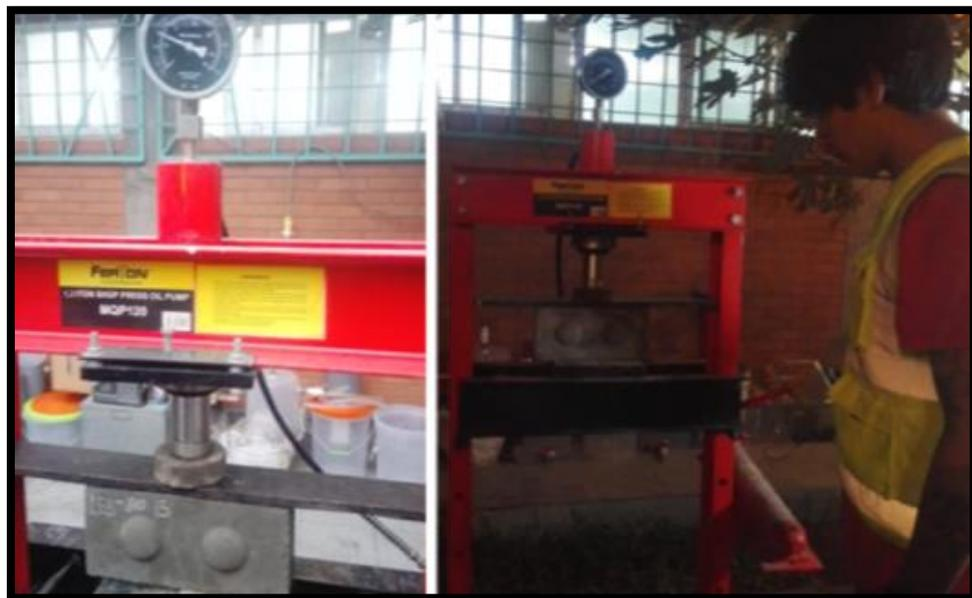
**Figura 64:** Cálculo de la carga máxima de los Ladrillos Ecológicos a base de biosólidos
