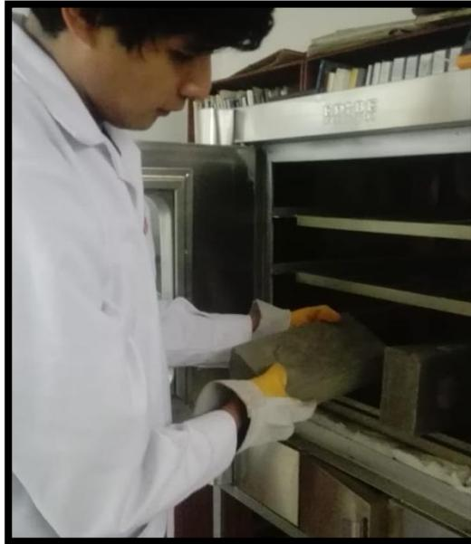
**Figura 60:** Secado de los ladrillos en estufa
