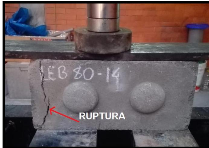
*Figura 66:* Punto de ruptura del LEB de malla N°18
