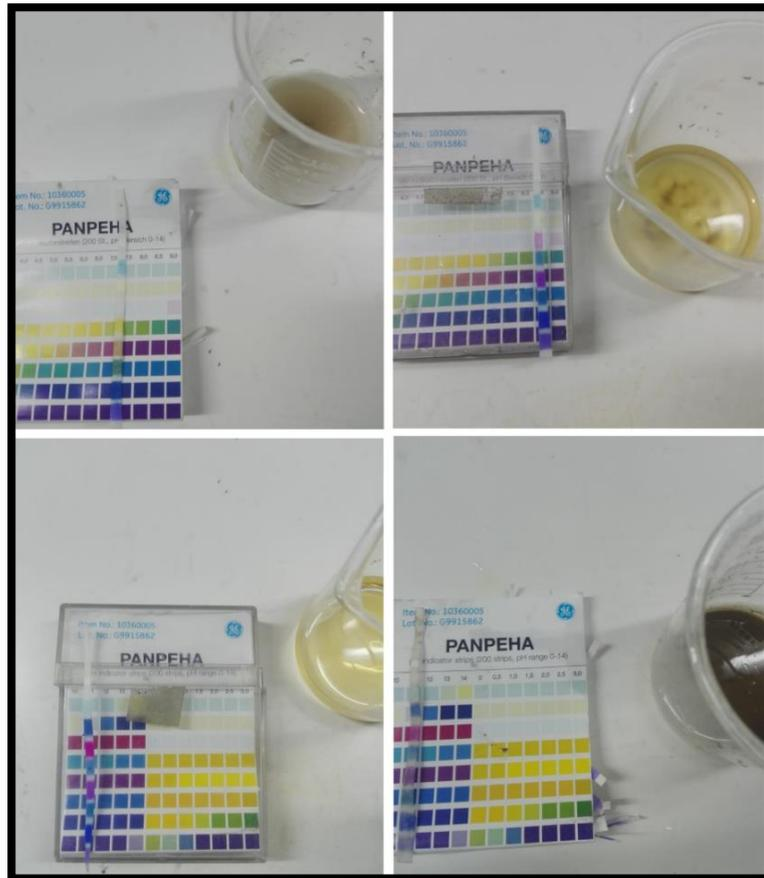
**Figura 39:** Medición de pH de muestras de biosólido decantadas
