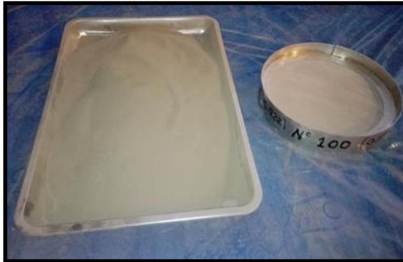
**Figura 20:** Biosólido tamizado a través de la malla N° -100
