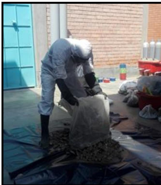
**Figura 11:** Vertido de muestras del biosólido
