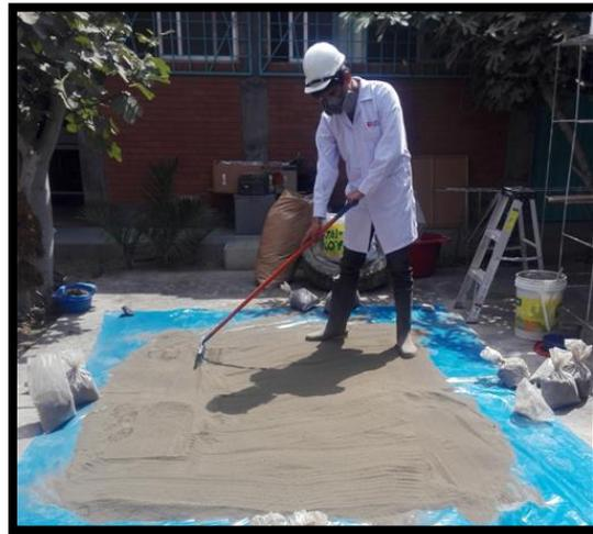
**Figura 14:** Homogeneización total de las muestras trituradas
