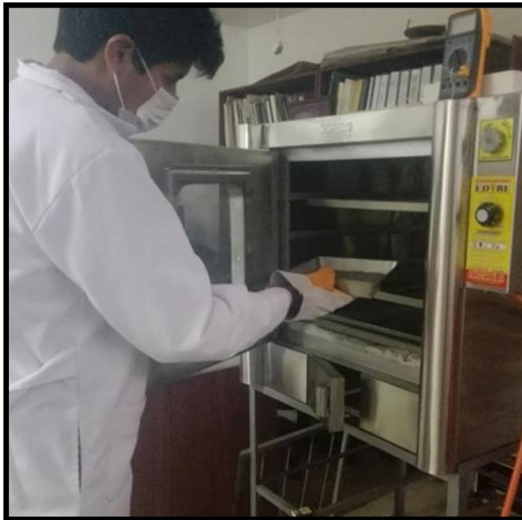
**Figura 25:** Secado de la muestra para el cálculo de la Densidad Relativa
