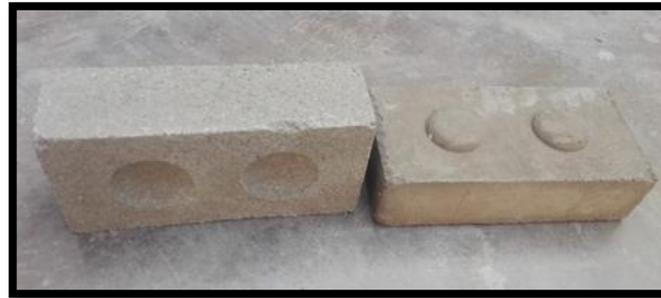
**Figura 51:** Ladrillo ecológico de biosólido prensado
