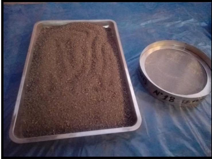
**Figura 18:** Biosólido tamizado a través de la malla N° 18
