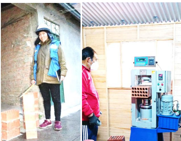
Ensayo a flexión por adherencia
