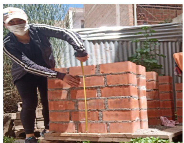
Especímen para el ensayo de corte diagonal
