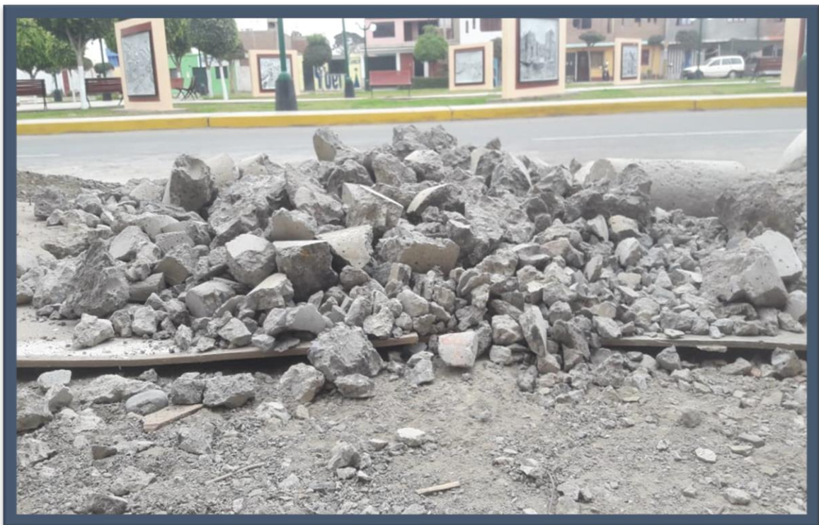
Foto 4. Agregado grueso reciclado
