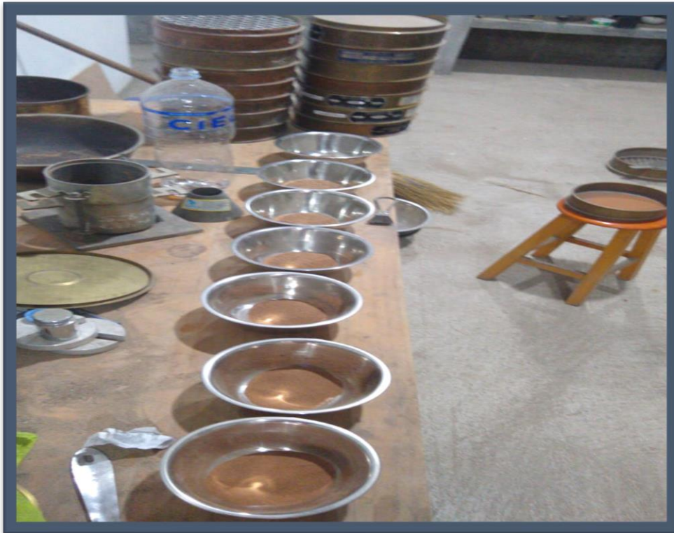
Foto 7. Tamizando de agregado fino
