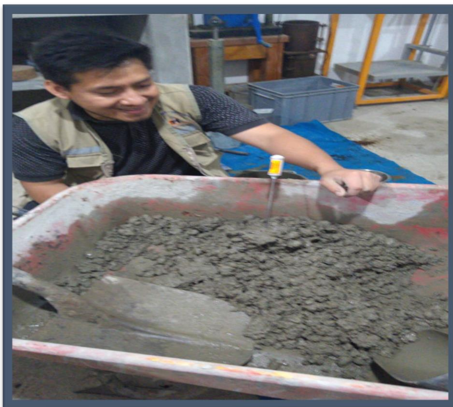
Foto 23. Se aplica el equipo de medición de temperatura en mezcla
