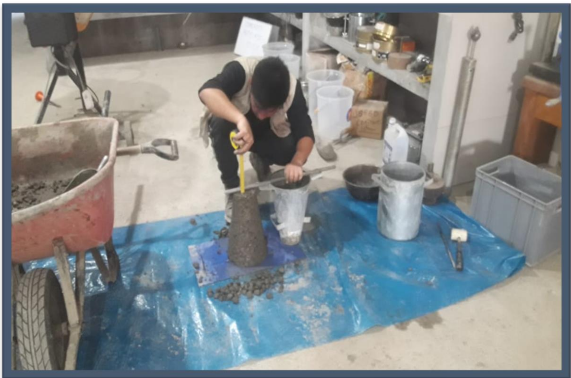
Foto 21. Slump de la muestra
