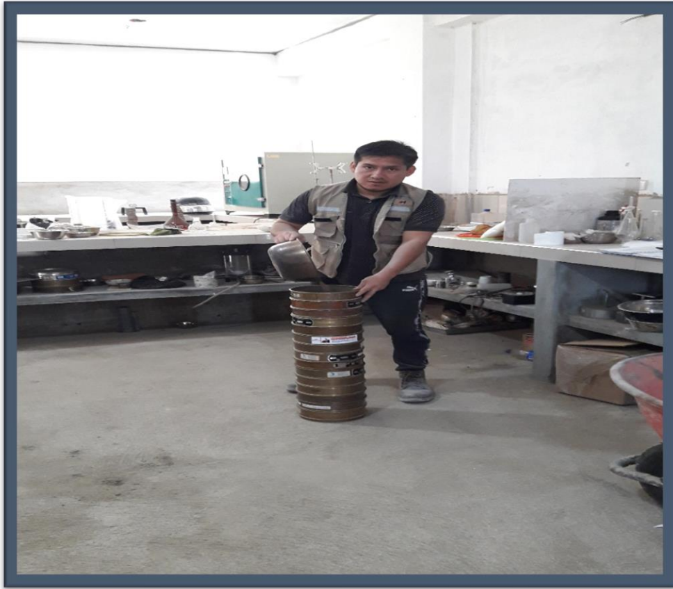
Foto 7. Tamizando de agregado fino
