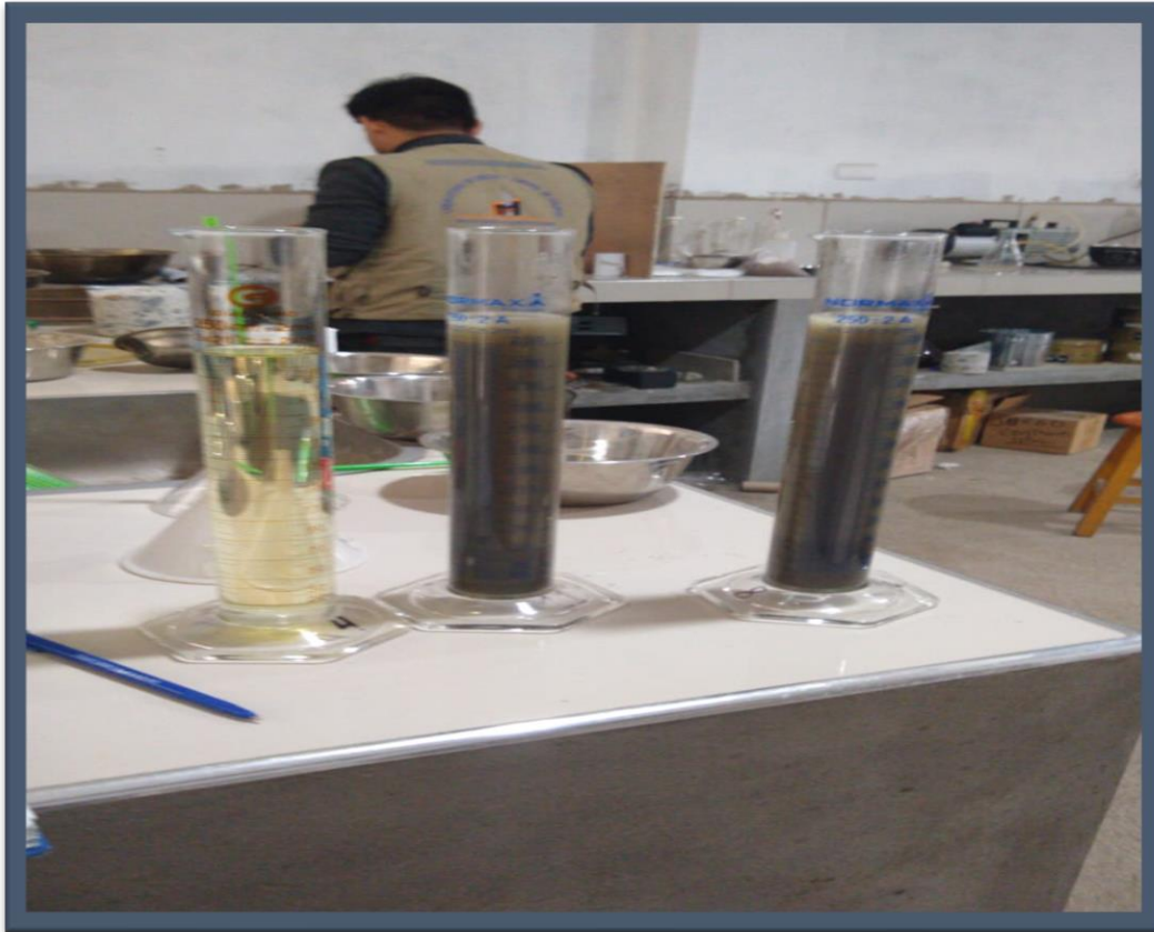
Foto 11. Ensayo de peso específico del cemento
