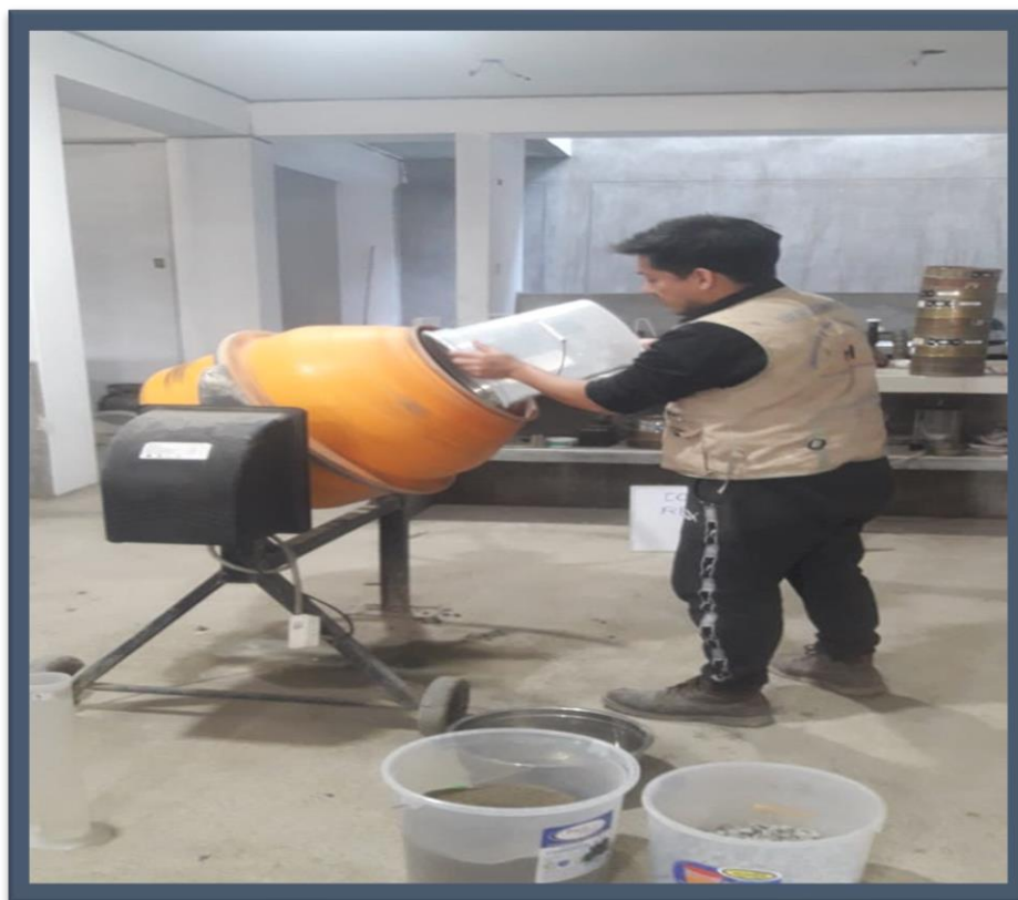
Foto 17. Vertiendo los agregados en la mezcladora
