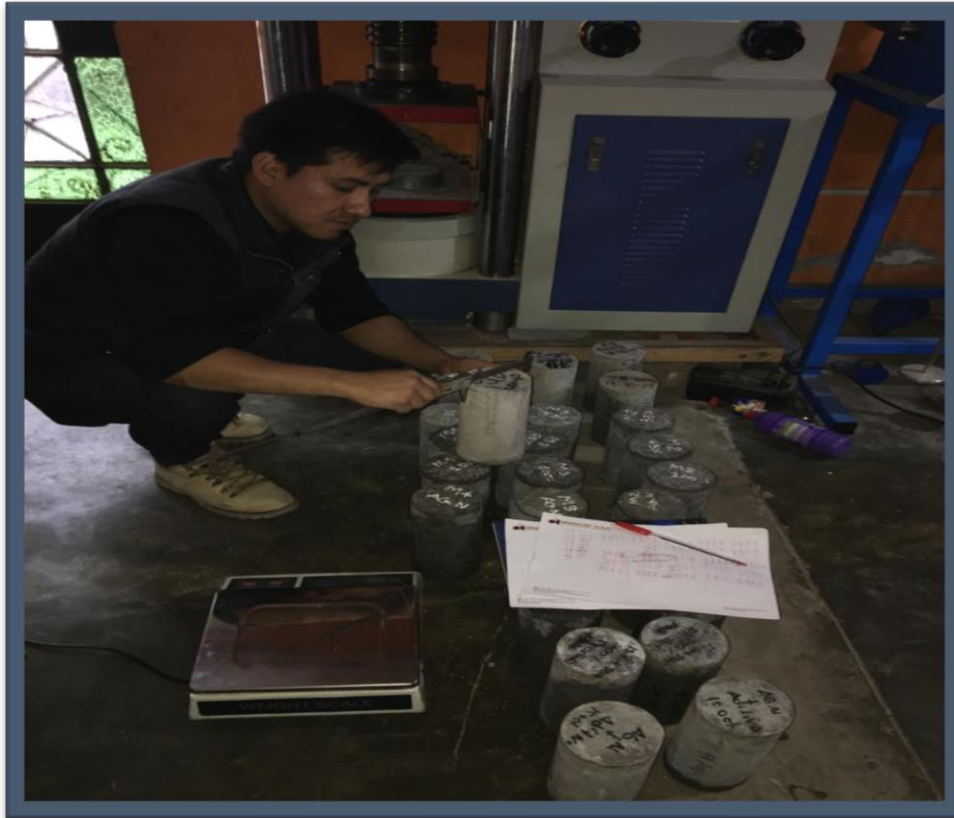
Foto 27. Anotando las dimensiones de las probetas
