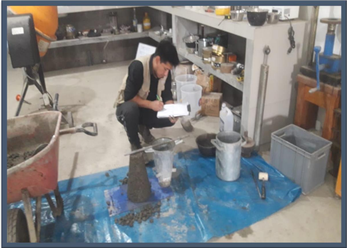
Foto 21. Slump de la muestra
