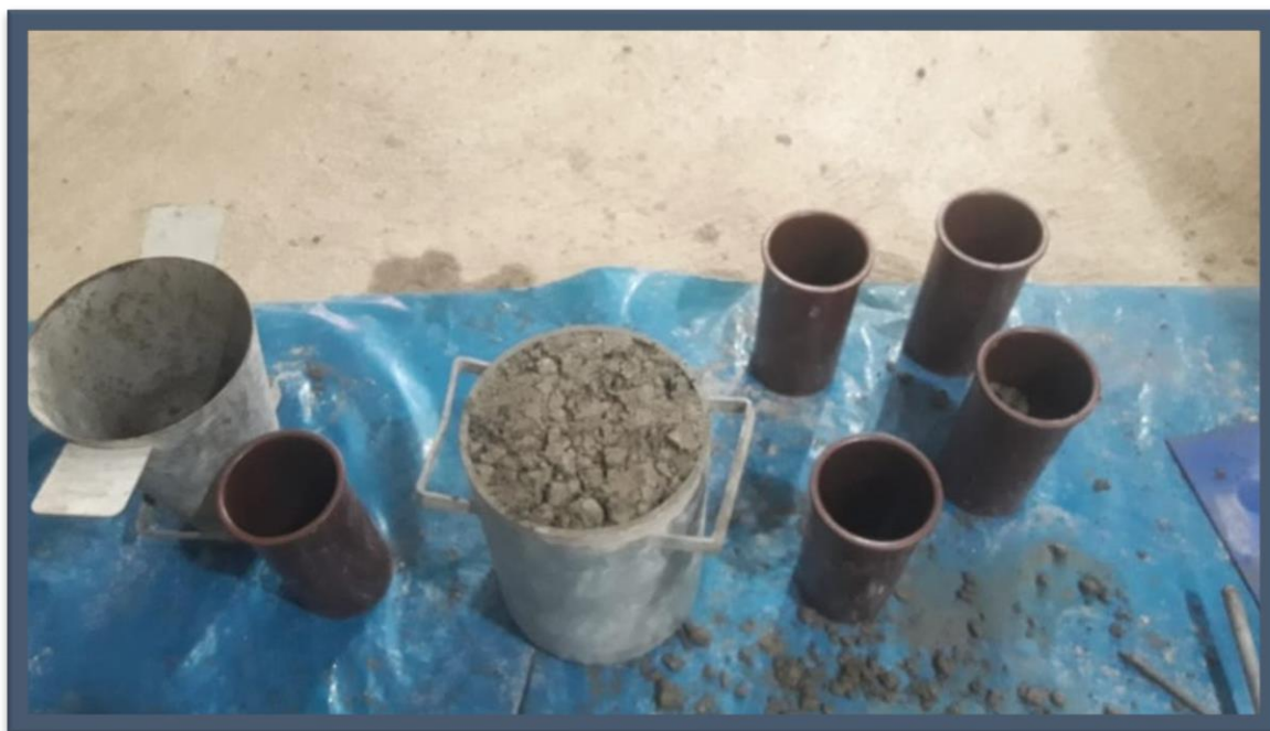
Foto 19. Mezcla fresca en el molde, para hallar su peso
