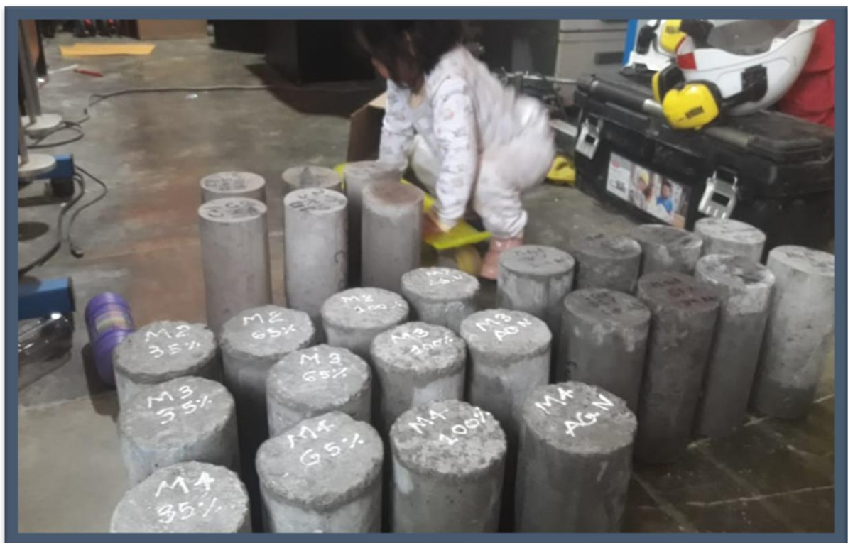
Foto 26. Probetas de diseño con 100 % ,65% y 35 % agregado grueso reciclado a ensayar
