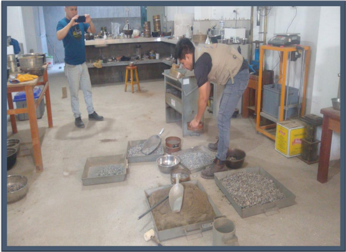
Foto 9. Zarandeo del agregado grueso
