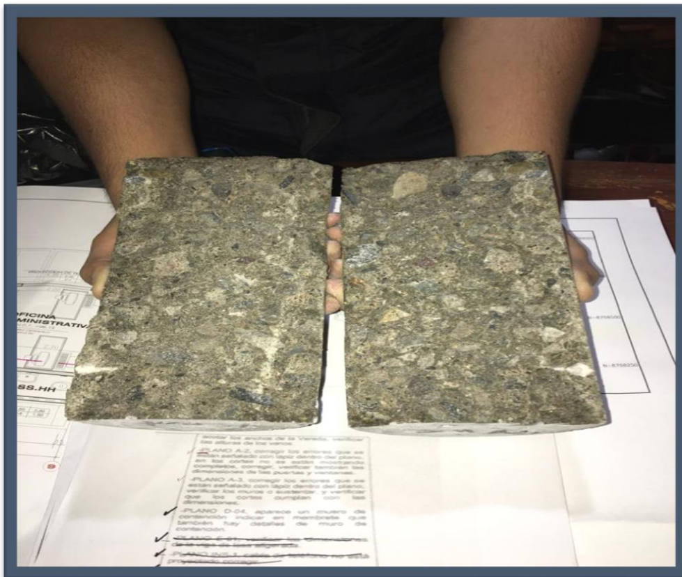
Foto 29. Ensayo de resistencia a la tracción
