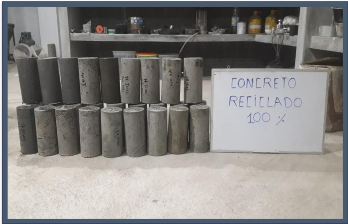
Foto 25. Probeta a los 7 días, diseño concreto 100 % agregado grueso reciclado
