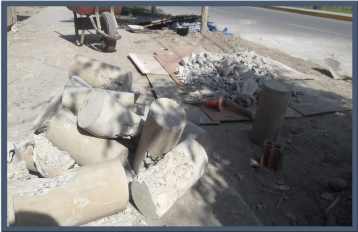
Foto 3. Probetas ensayadas de resistencias que están entre los 300 – 400 kg/cm 2 .
