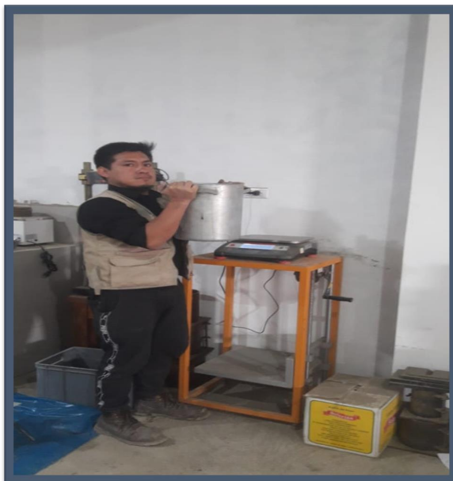
Foto 19. Mezcla fresca en el molde, para hallar su peso
