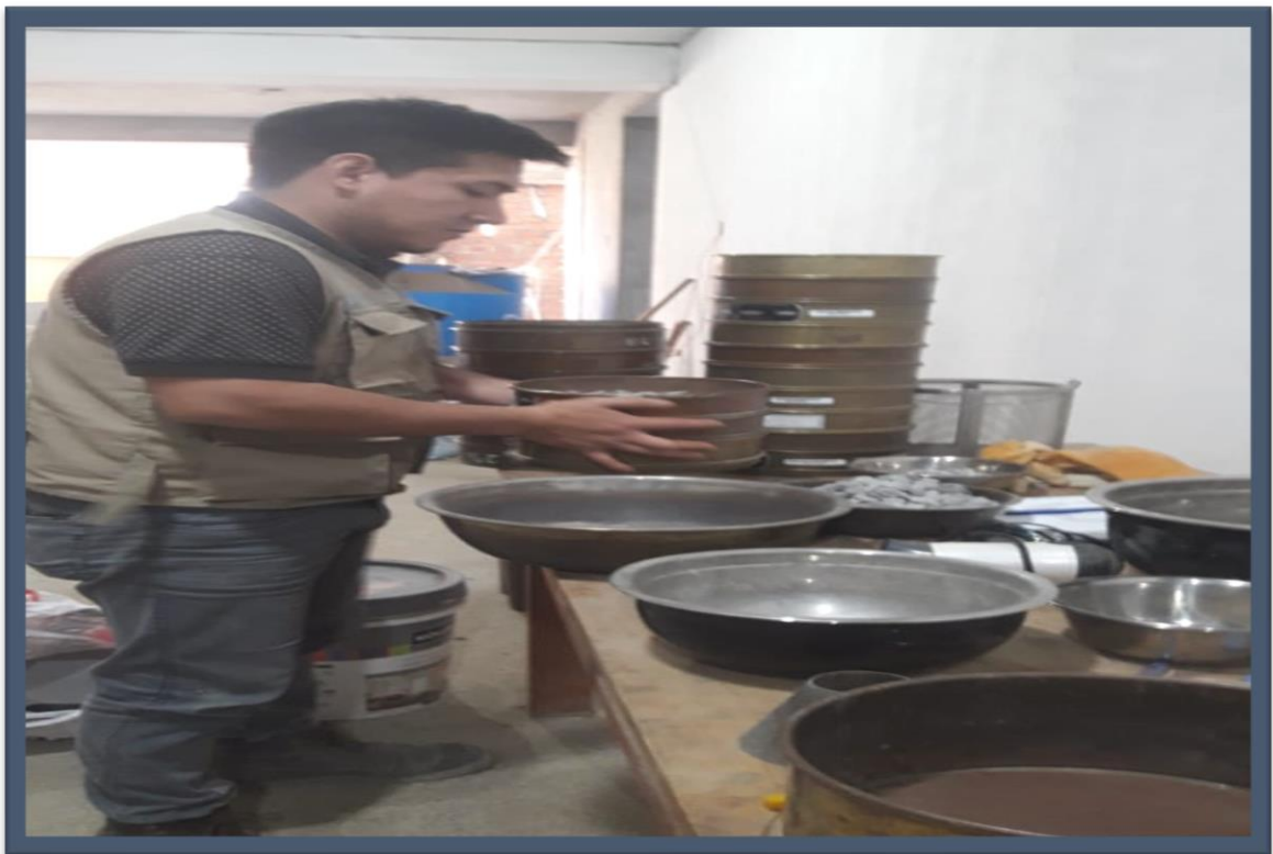
Foto 9. Zarandeo del agregado grueso
