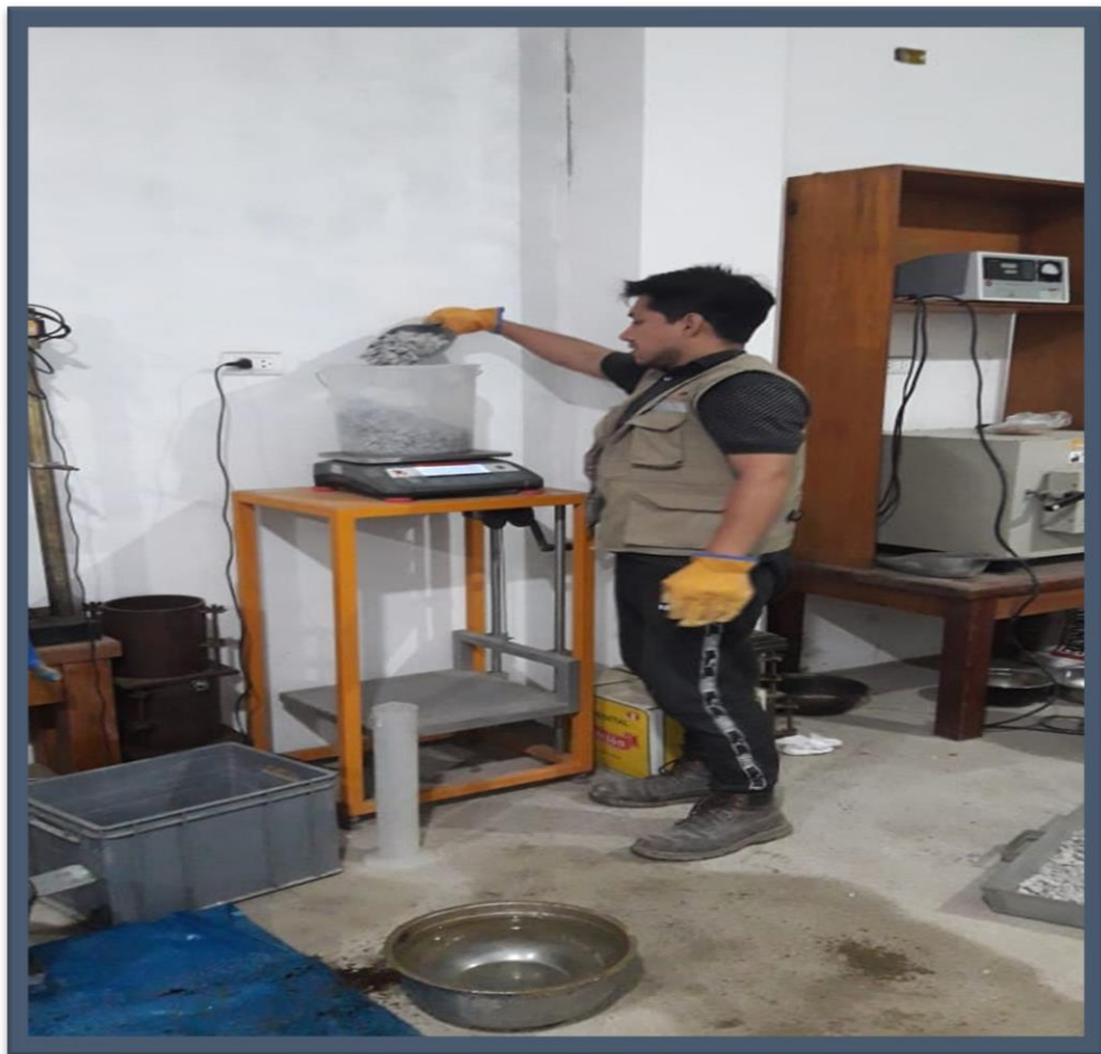
Foto 13. Peso suelto del árido grueso
