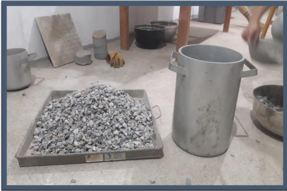
Foto 13. Peso suelto del árido grueso
