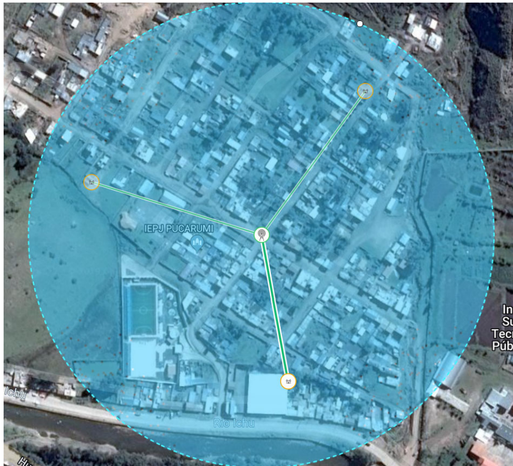
Figura 27. Tecnología P2MP para acceso a red inalámbrica en el Anexo de Pucarumi. Fuente: AirLink (2019)
