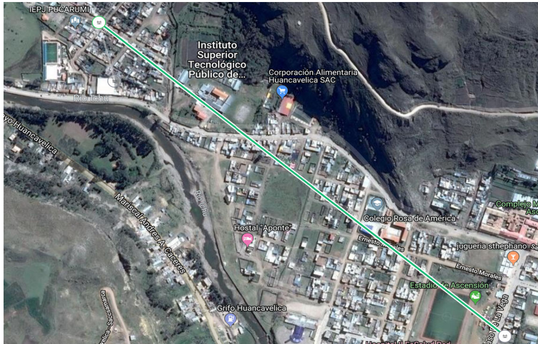
Figura 26. Tecnología P2P (Ascension – Pucarumi) para acceso a red inalámbrica. Fuente: AirLink (2019)
