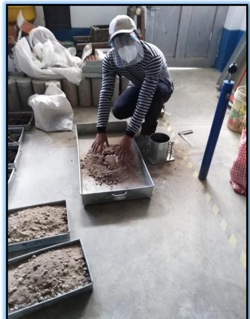
Figura 12: muestra para el ensayo de Proctor modificado
