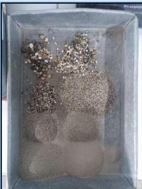
Figura 11: resultado del tamizado de la muestra
