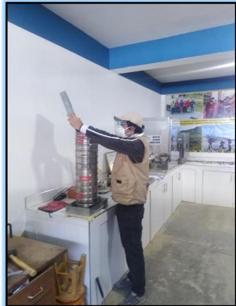
Figura 10: proceso de tamizado de la muestra
