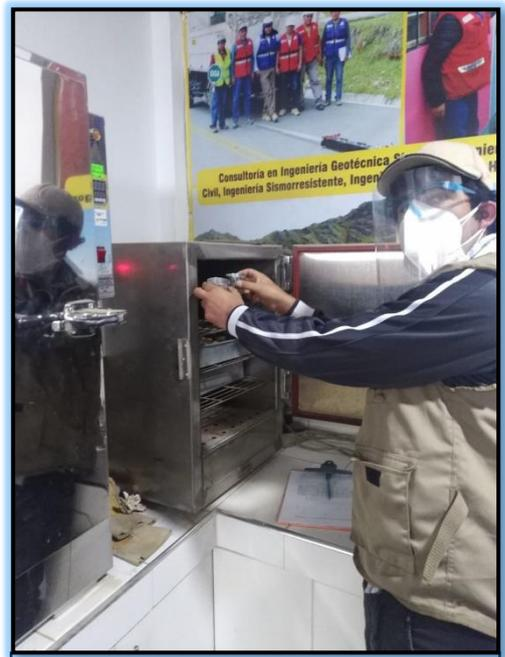
*Figura 16: secado de muestras en el horno*
