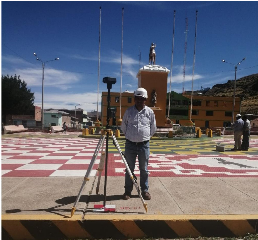
Imagen N° 02 Se observa equipo topográfico para inicio de vuelo drone phantom 4RTK, lugar plaza de armas Pisacoma
