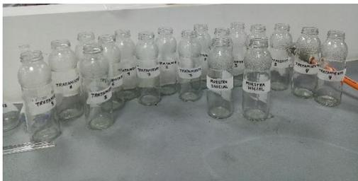
**Figura 15:** Botellas esterilizadas para la determinación de DBO5
