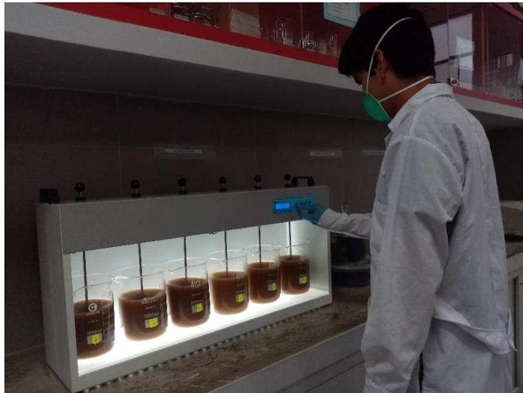
*Figura 18: Agitación en el equipo de test de jarras*
