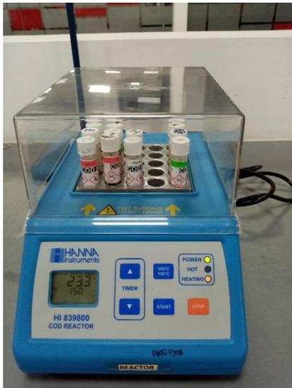
**Figura 13:** Tubos de digestión en el reactor para la determinación de DQO
