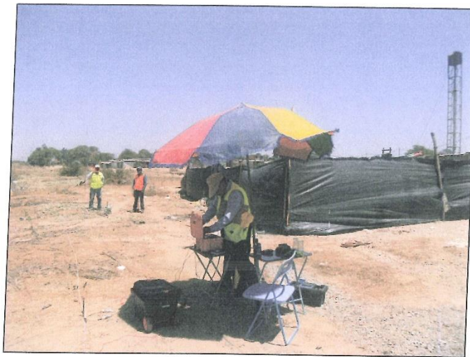
Ejecución de Sondajes Eléctricos Verticales-SEVs y toma de datos de campo.
