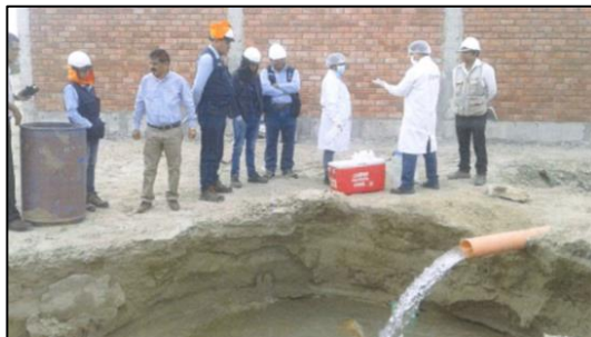
Figura 19. Prueba de Bombeo y Toma de Muestras para calidad del agua
