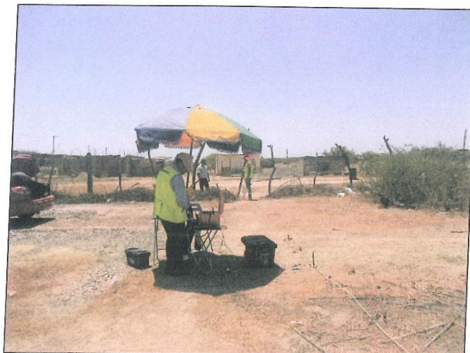
Ejecución de Sondajes Eléctricos Verticales-SEVs y toma de datos de campo.
