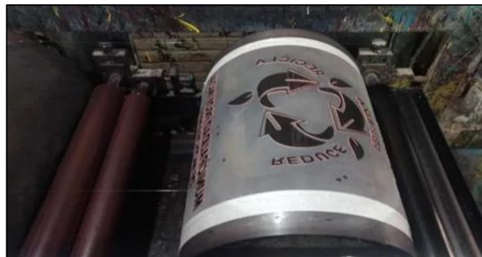
Figura N° 31: Rodillo de impresión
