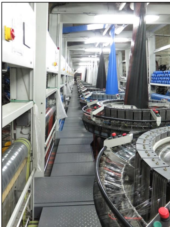
Figura N° 21: Telares y mangas
