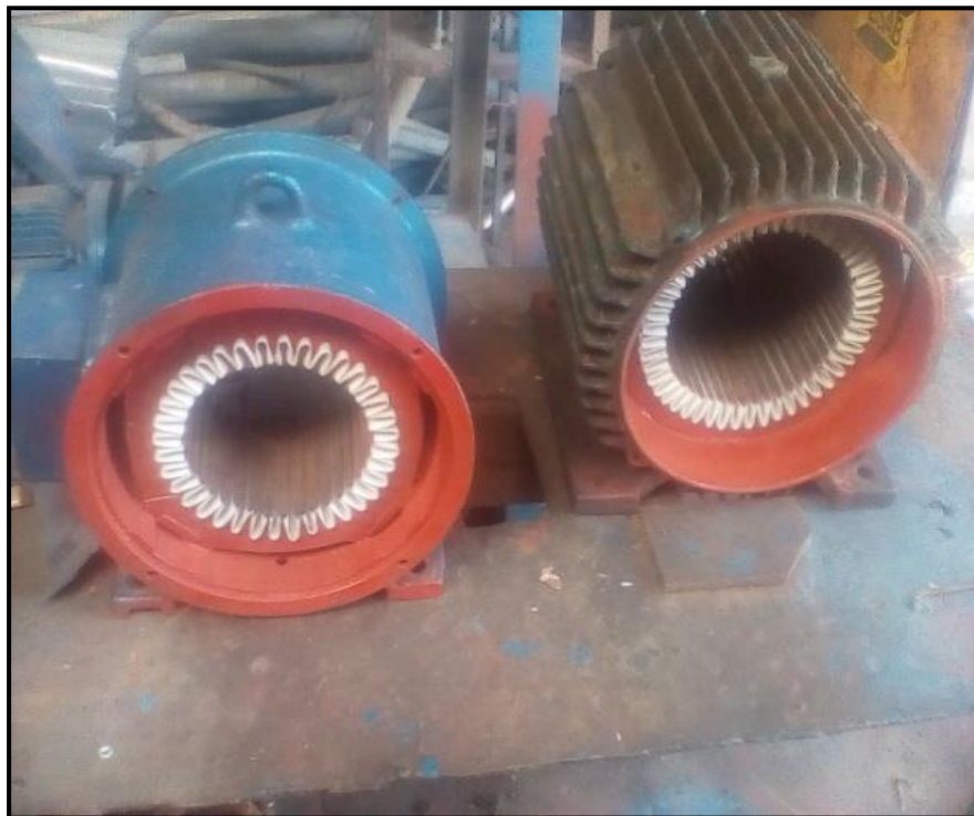
Figura 4. Rebobinado de motores.
