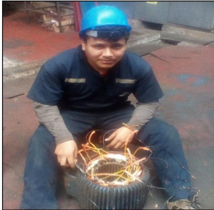
Figura 2. Extracción del bobinado.
