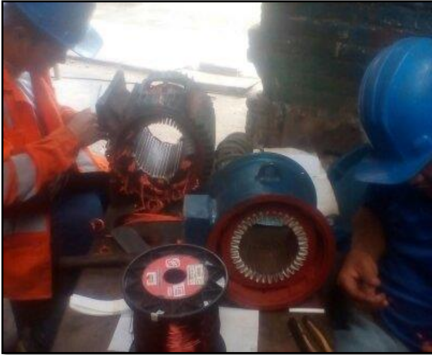
Figura 3. Aislamiento de ranuras con papel Nomex.
