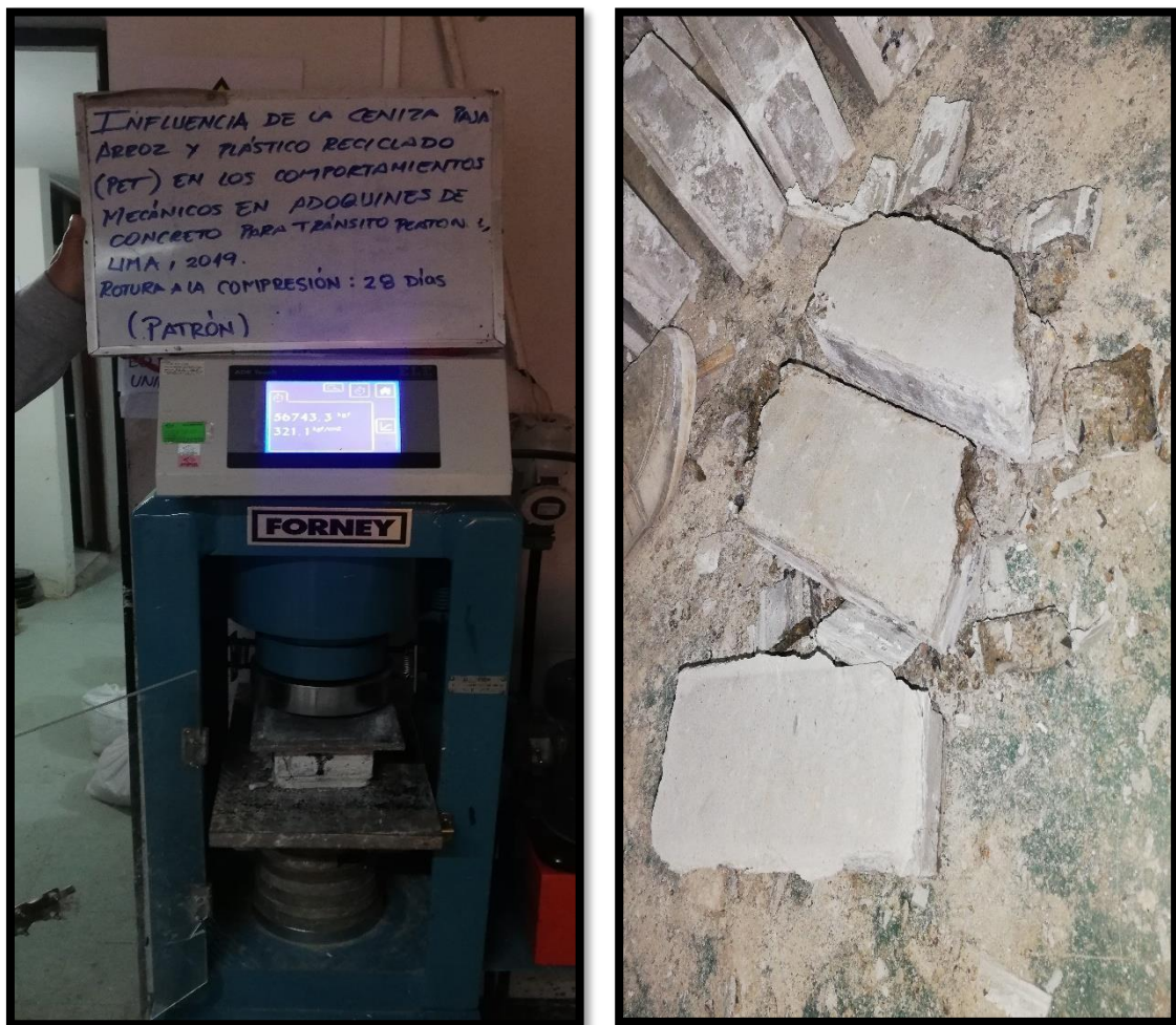
Figura 13: Rotura a la compresión.
