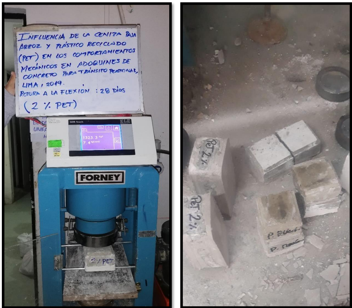
Figura 14: Rotura a la flexión.
