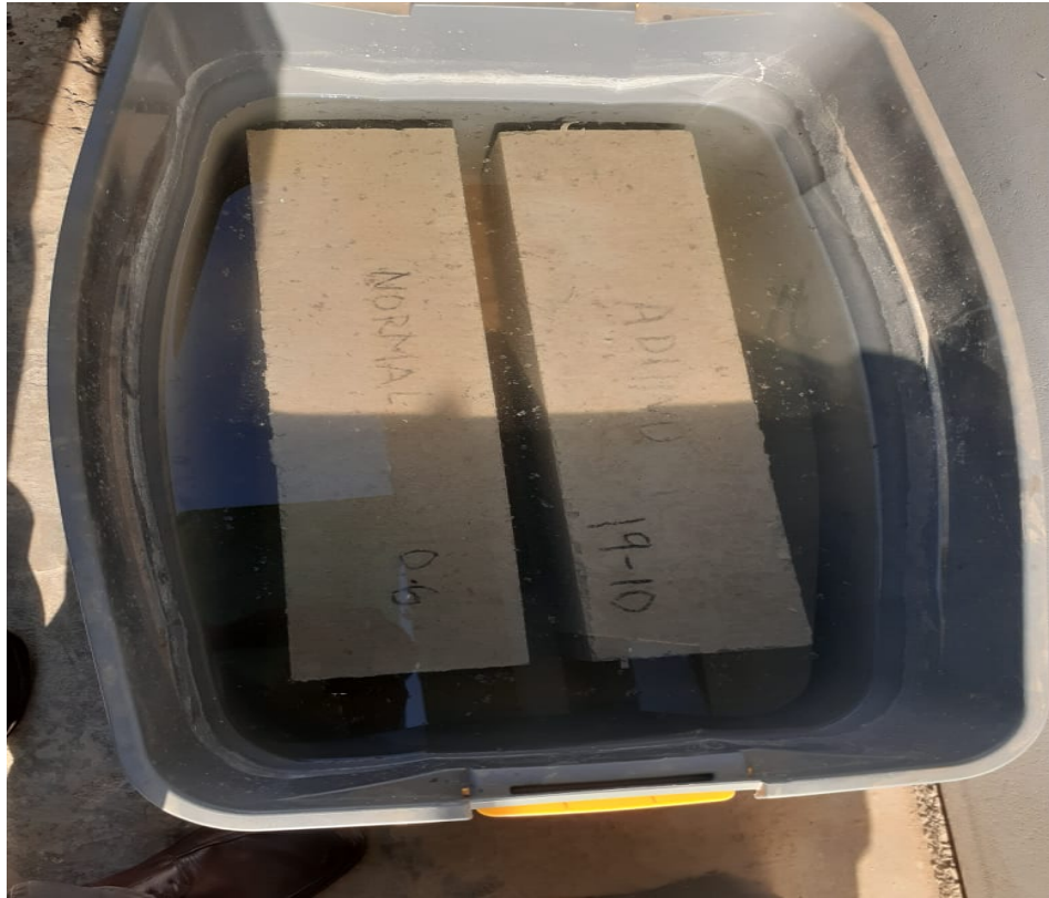
Figura 4 Probetas prismáticas, para poder realizar el ensayo a flexión.
