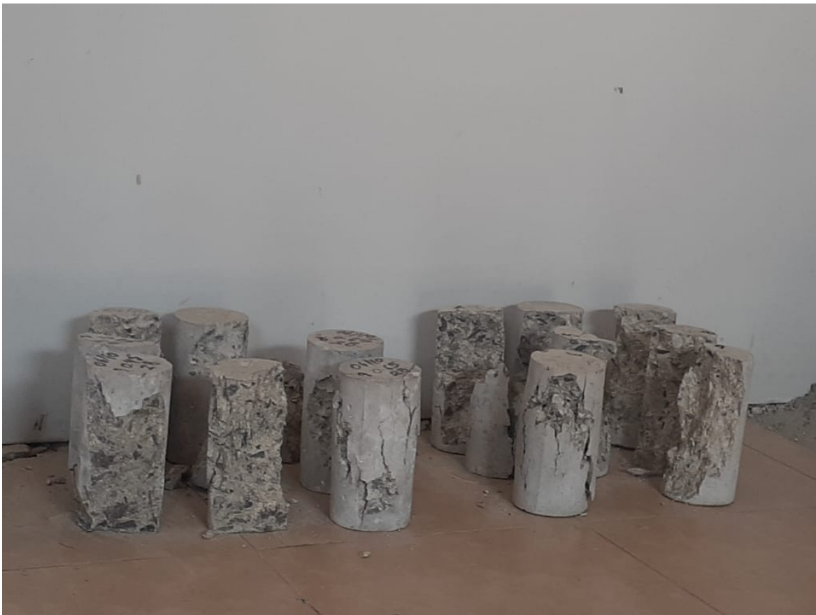
Figura 8 Probetas ensayadas a compresión con distintos tipos de rotura.
