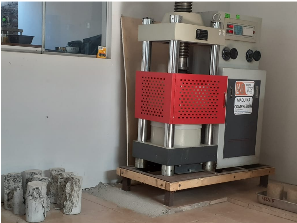
Figura 6 Máquina compresora junto a probetas ensayadas.
