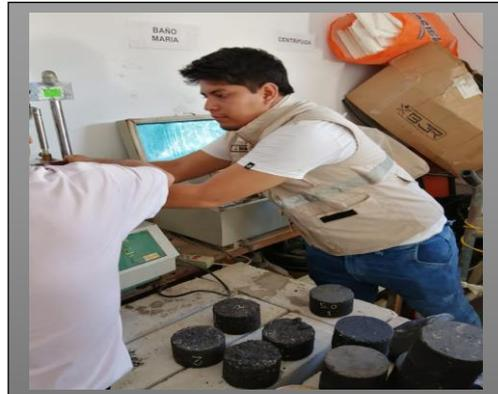
Rotura de briqueta- Prensa Marshall
