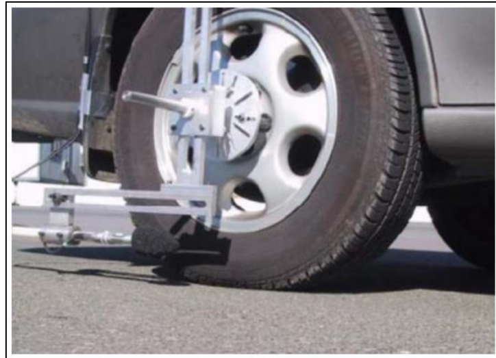
Figura 14. Sistema On-board sound intensity (OBSI) Fuente: Jara (2013)
