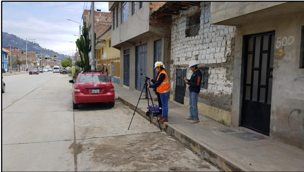
Fotografía 3. Medición de ruido carretera Huaraz - Palmira
