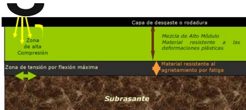
Figura 5. Estructura del Pavimento de larga duración Fuente: The Asphalt Institute (2000)
