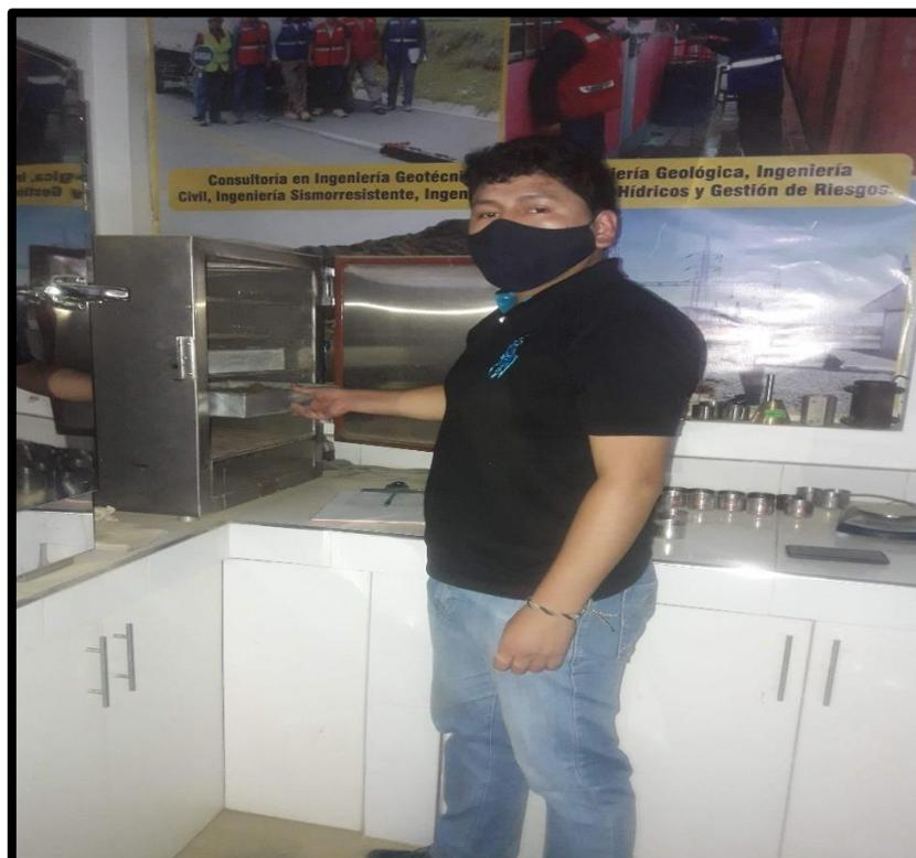
Fotografía N°09. Muestra en el horno a una temperatura de 110 °C, para hallar el contenido de humedad y límite líquido
