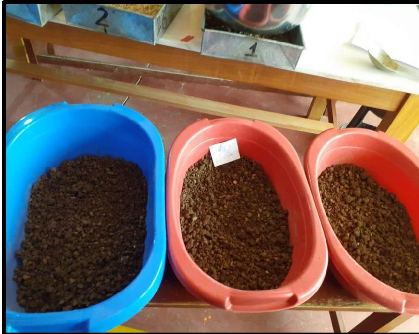
Fotografía N°10. Capas para el ensayo de Proctor
