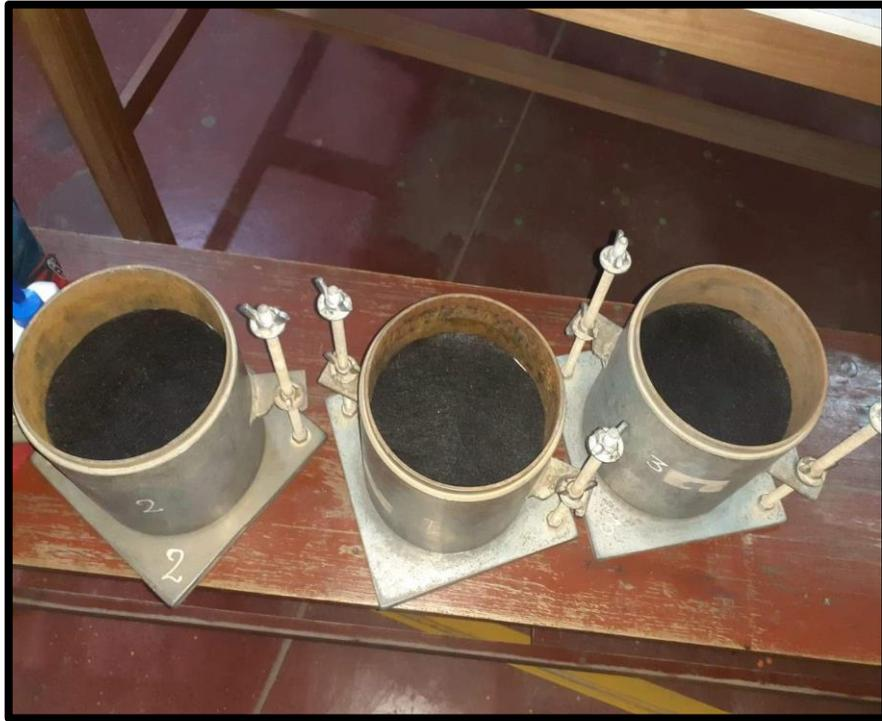
Fotografía N°12. Ensayo de Proctor modificado
