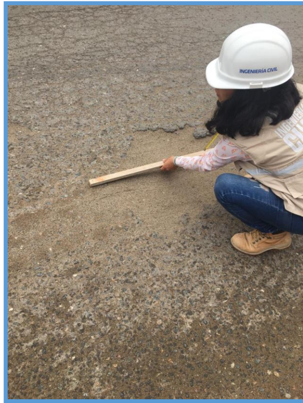
Fg 5. Medición del diámetro bache o hueco.
