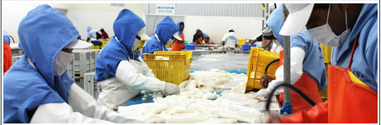
Ilustración 3: proceso de fileteo de la pota
