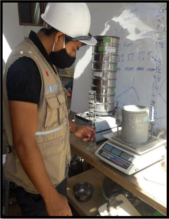
Figura N°14: Ensayo de CBR con porcentaje de 4%,7% y 10% de ceniza de cascara de arroz
