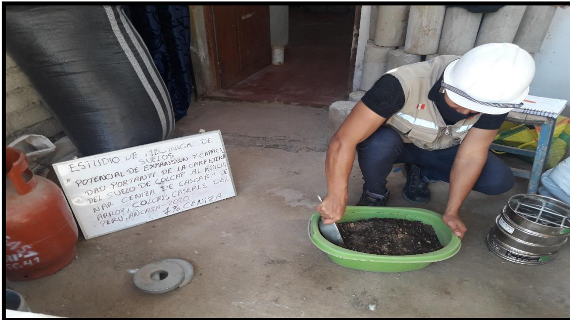
Figura N°12: Ensayo de Proctor modificado con porcentaje de 7% de ceniza de cascara de arroz
