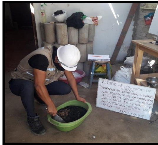
Figura N°13: Ensayo de Proctor modificado con porcentaje de 10% de ceniza de cascara de arroz
