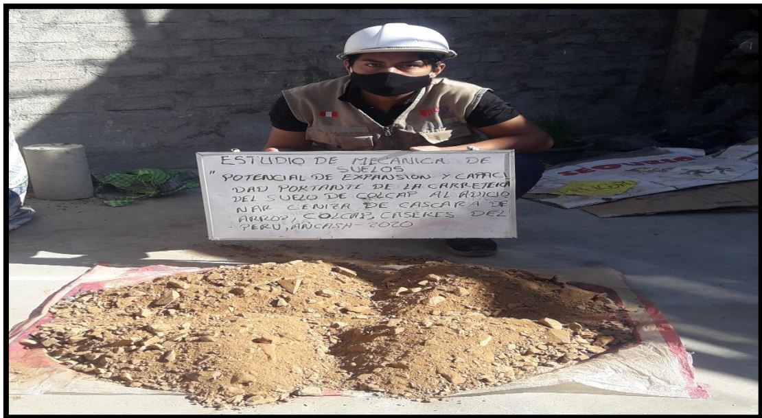
Figura N°8: Cuarteo de la muestra para realizar el ensayo de granulometría
