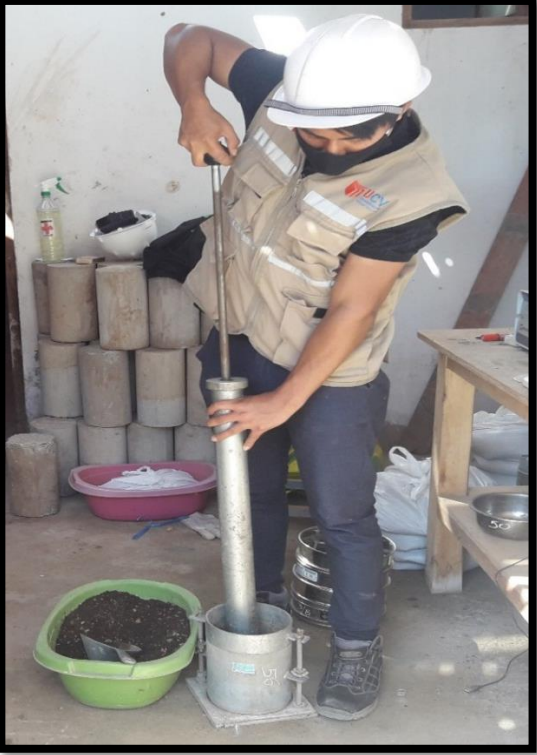
Figura N°14: Ensayo de CBR con porcentaje de 4%,7% y 10% de ceniza de cascara de arroz
