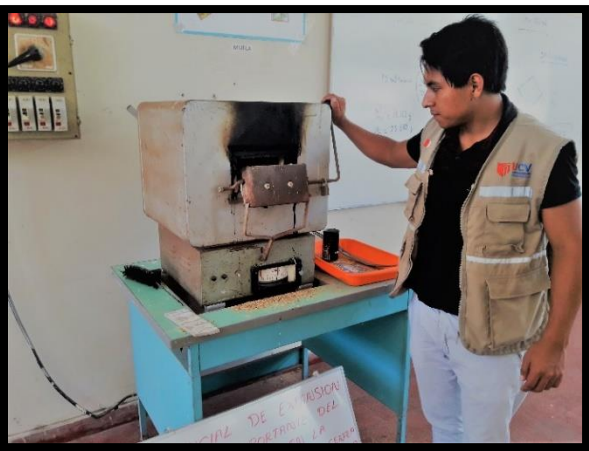
Figura N°3: proceso de calcinación de la cascarilla de arroz
