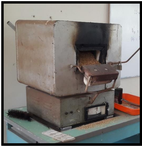
Figura N°3: proceso de calcinación de la cascarilla de arroz
