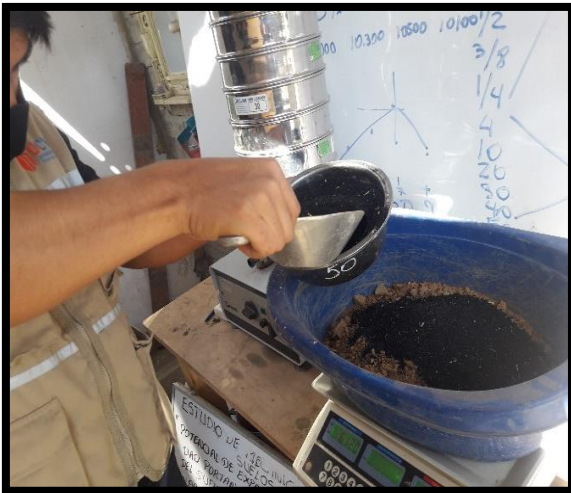
Figura N°11: Ensayo de Proctor modificado con porcentaje de 4% de ceniza de cascara de arroz
