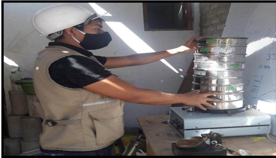
Figura N°10: Ensayo de límites de Atterberg con porcentajes de 4%, 7% y 10% de ceniza de cascara de arroz
