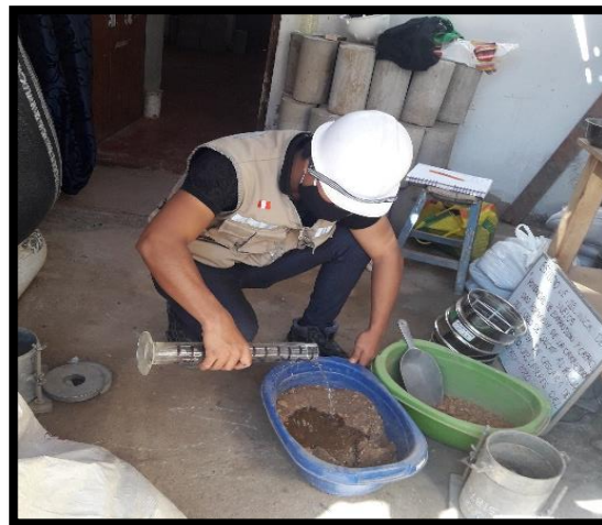
Figura N°11: Ensayo de Proctor modificado con porcentaje de 4% de ceniza de cascara de arroz
