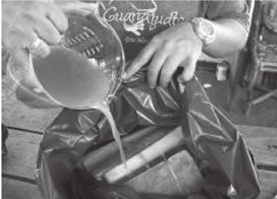
Figura 02. Pre digestión de pencas con generador bacteriano
