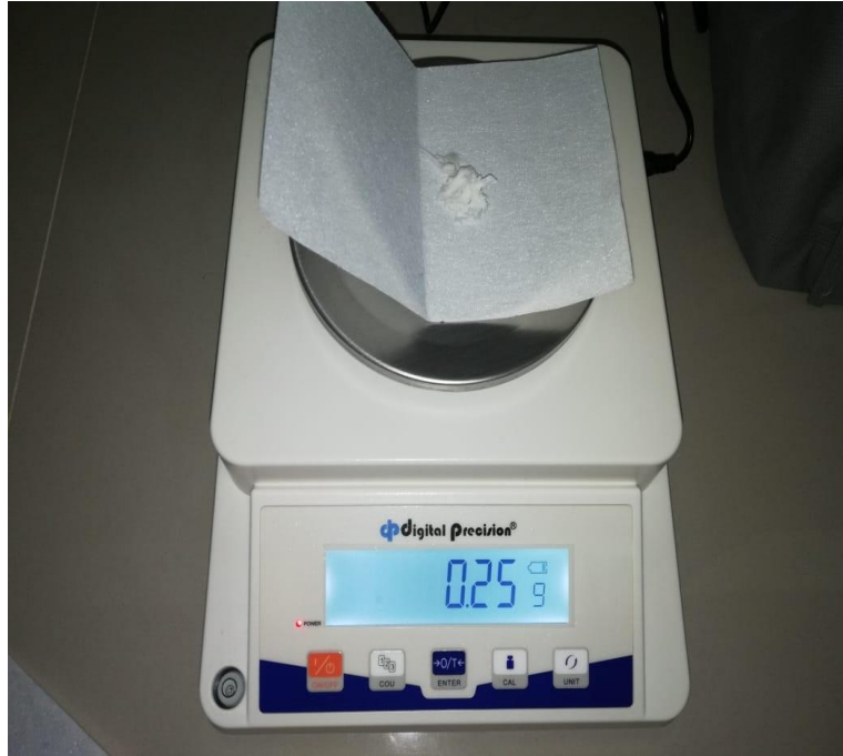
Pesaje del plástico en polvo después del tratamiento
