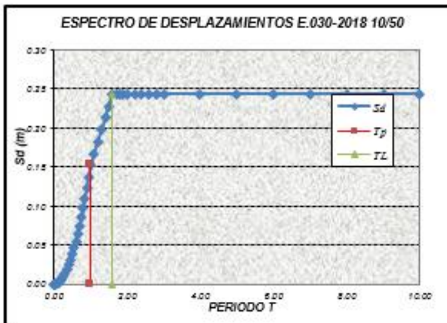
Espectro de capacidad-según E-30-2018
