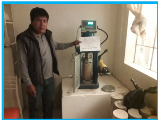
Figura 42 Muestra de ruptura con el 1.5% de totora alcanzo una resistencia mínima de 17.55 kg/cm 2
