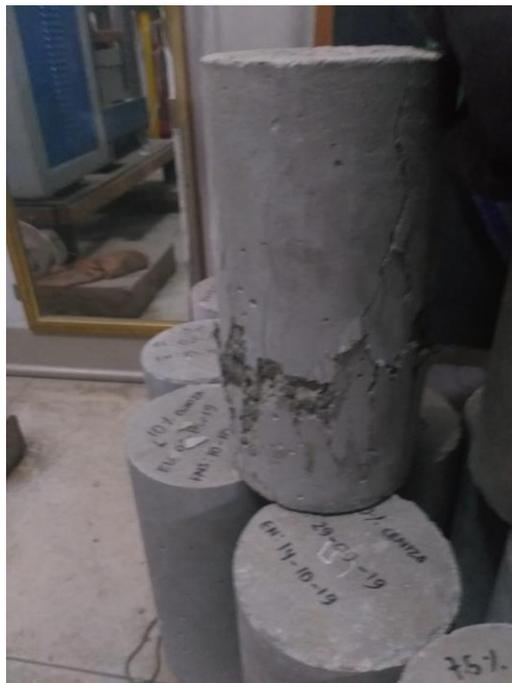
**Figura 44.** Probetas post ensayo de resistencia a compresión.
