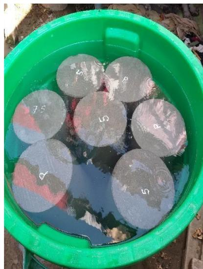
**Figura 43.** Probetas desenfofradas y proceso de curado
