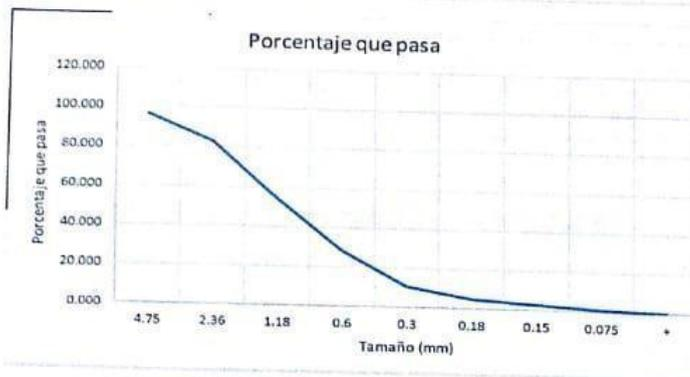
**Módulo de Finura (MF):**  $MF = \frac{\sum \% \text{ retenido acumulado en los tamices (hasta \#100)}}{100}$
