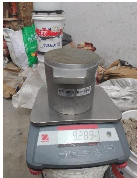
**Figura 41.** Compactado y pesado de la mezcla de concreto para determinar su peso específico.
