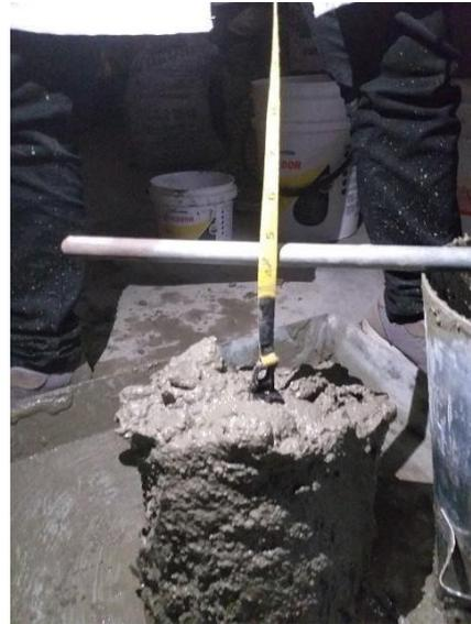
**Figura 42.** Compactado con varilla (25 veces) para el ensayo de asentamiento.
