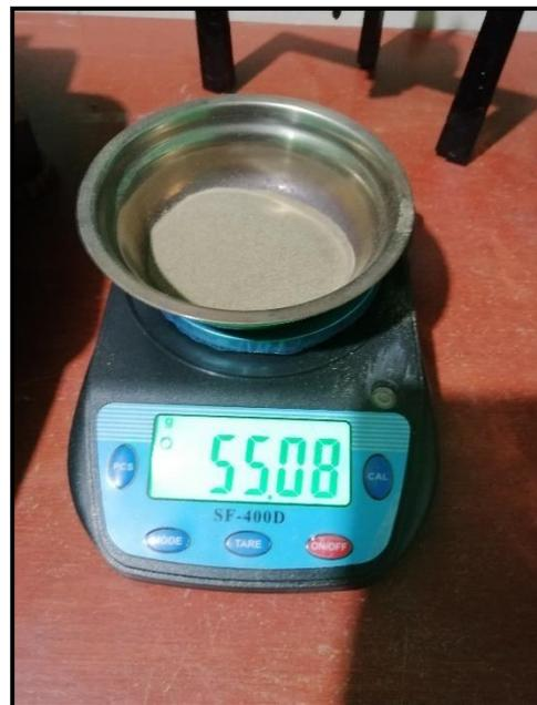
**Fotografía N°16:** Peso de la muestra retenida por la malla N°200 de la calicata 3
