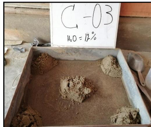
**Fotografía N°20:** mezclado de la muestra con 12% de agua hasta homogenizar la masa.
