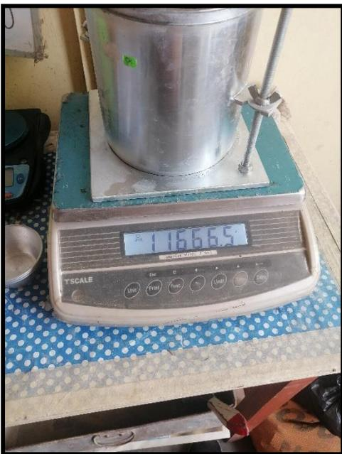
**Fotografía N°27:** Peso de uno de los moldes a utilizar
