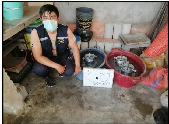
**Fotografía N°34:** inmersión de los moldes del CBR adicionando 8% de Vidrio Reciclado
