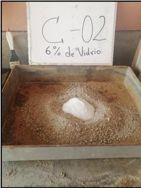
**Fotografía N°29:** muestra de 6 kg con adición de vidrio reciclado al 6%
