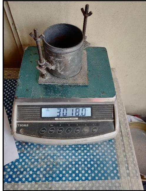
**Fotografía N°22:** Peso del molde a utilizar para el Proctor Modificado
