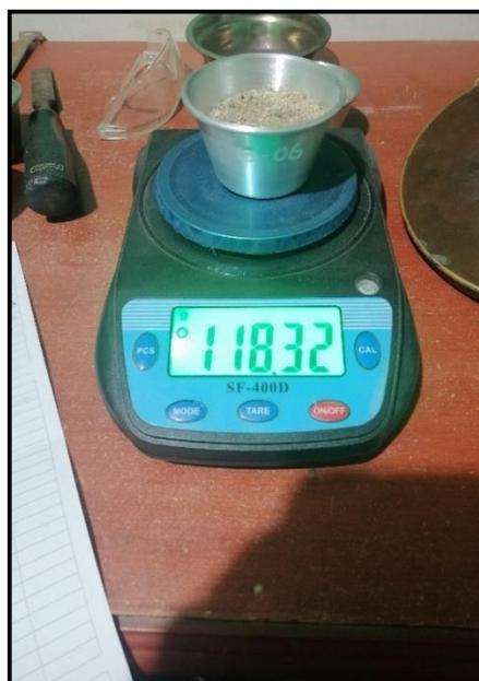
**Fotografía N°12:** Peso inicial de la Calicata 1 para poder determinar el porcentaje de humedad
