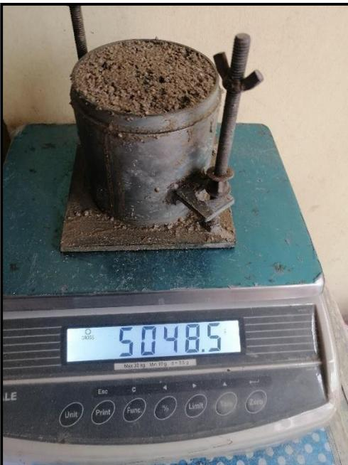
**Fotografía N°23:** Peso del molde más la muestra compactada adicionando el vidrio reciclado
