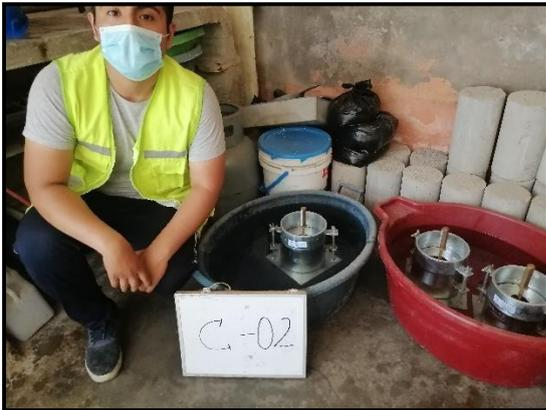
**Fotografía N°33:** inmersión de los moldes del CBR para la calicata 2
