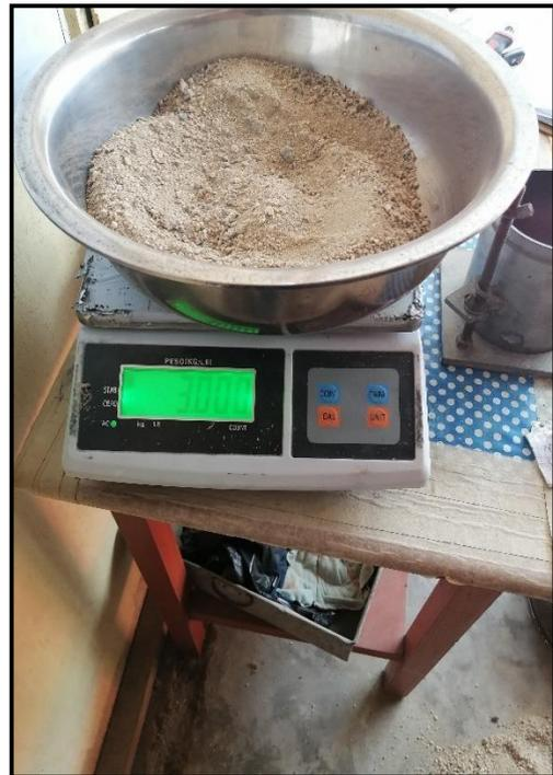
**Fotografía N°18:** se procedió a pesar una muestra de 3kg, para realizar el ensayo del Proctor.
