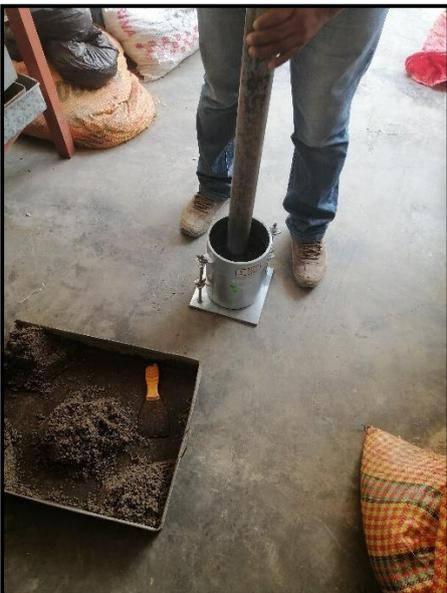
**Fotografía N°31:** Proceso de compactado a 25 golpes para el CBR
