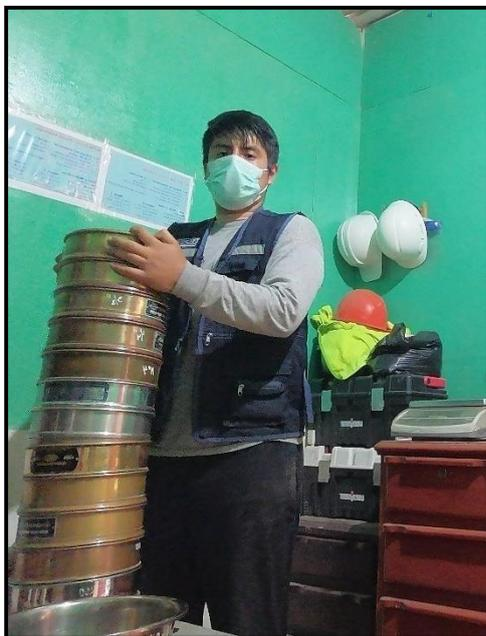
**Fotografía N°15:** Proceso de tamizado para el ensayo granulométrico de la calicata 3
