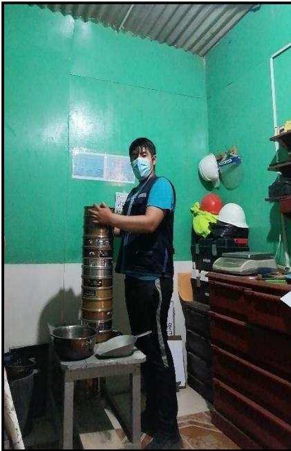
**Fotografía N°13:** Proceso de tamizado para el ensayo granulométrico de la calicata 1
