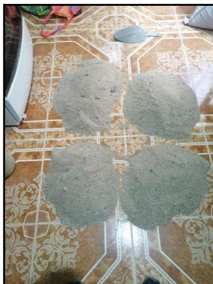
**Fotografía N°10:** Proceso de cuarteo de la Muestra 1
