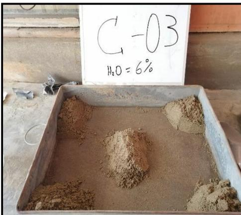
**Fotografía N°19:** mezclado de la muestra con un 6% de agua hasta homogenizar
