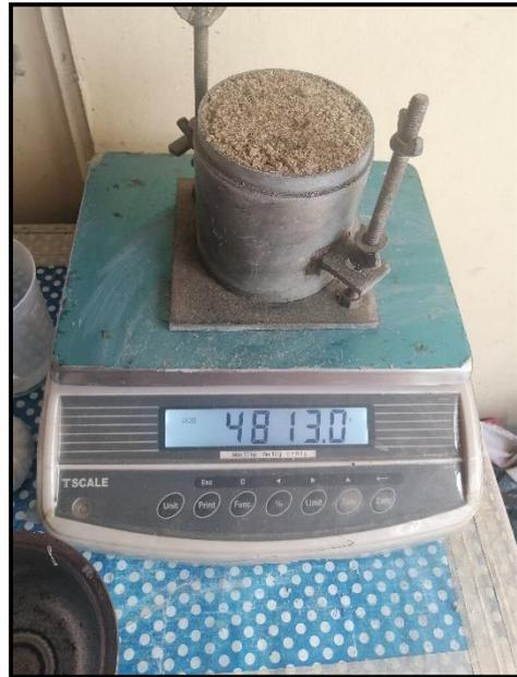
**Fotografía N°30:** peso de la muestra compactada a 12 golpes
