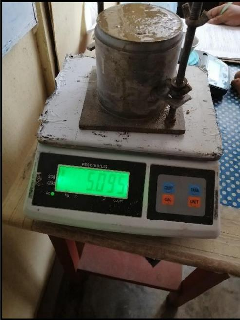
**Fotografía N°25:** Peso de una muestra, observándose saturada
