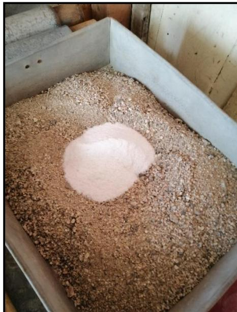
**Fotografía N°28:** muestra de 6 kg con adición de vidrio reciclado al 8%
