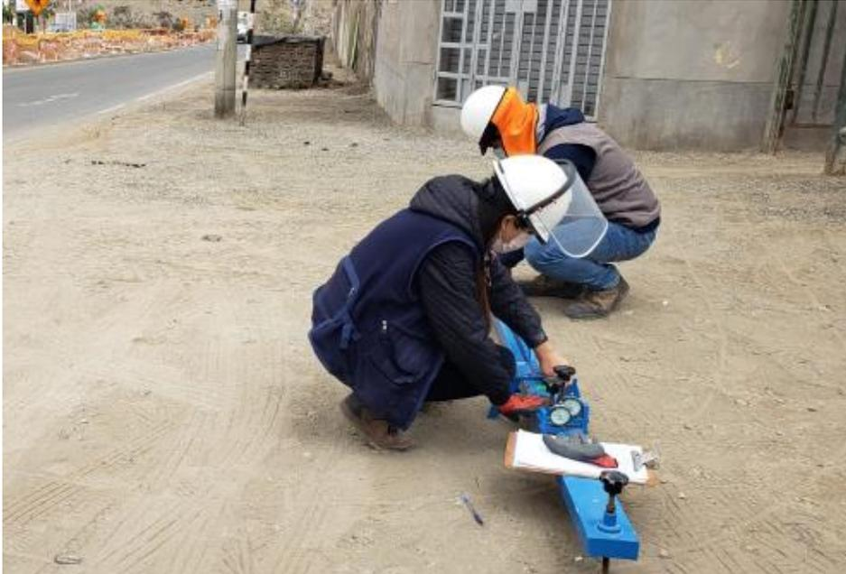
Leyenda: Se empezó armar la viga benkelman ajustando los pernos que corresponde.
