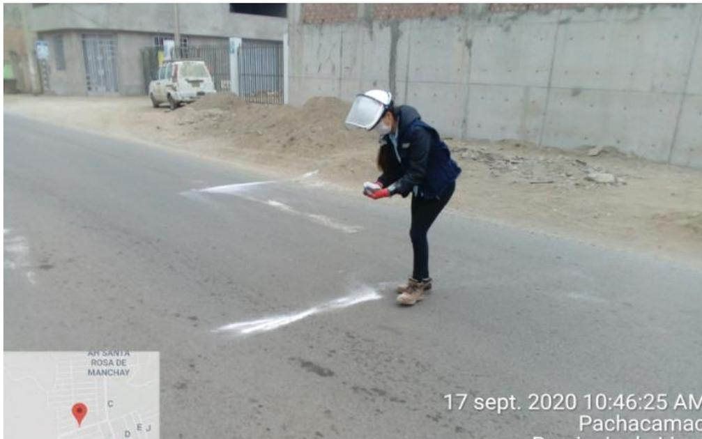
Leyenda: Ensayo estructural del pavimento flexible existente, se inicia marcando con yeso cada 25 metros cada carril derecho, izquierdo y central.
