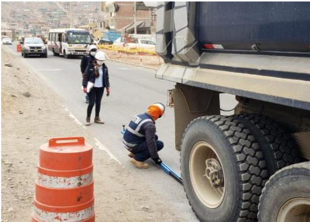
Leyenda: Se ubico la viga benkelman en el eje del camión para dar inicio al ensayo en el carril derecho.
