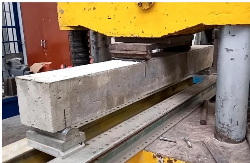
*Figura 20. Ensayo de flexión*
