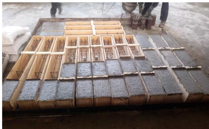
*Figura 13. Colocación de concreto en el día 1*
