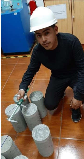
Medición de diámetro de briquetas con vernier
