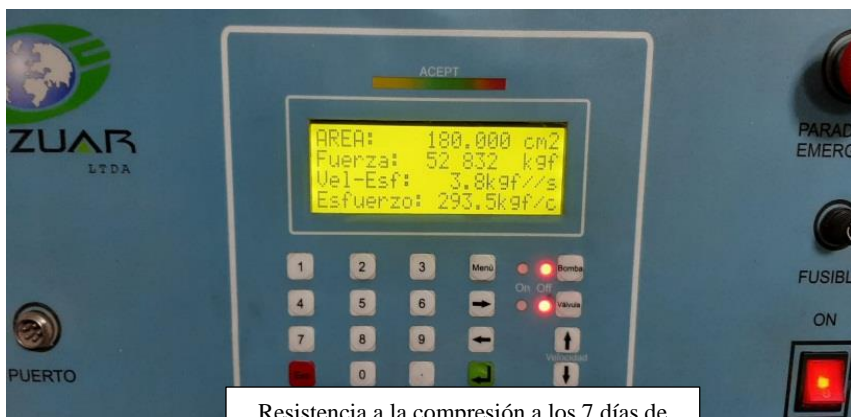
Resistencia a la compresión a los 7 días de edad con 0.06% de fibra de vidrio
