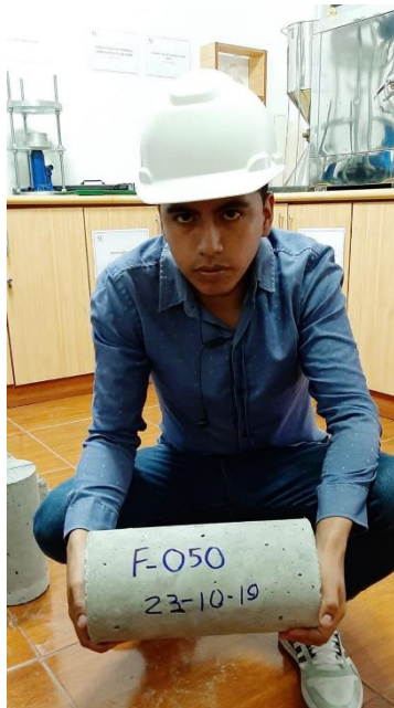
Briqueta con 0.50% de fibra de vidrio a los 28 días de curado.
