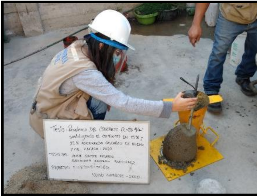
Fotografía 21. Ensayo de consistencia del concreto.
