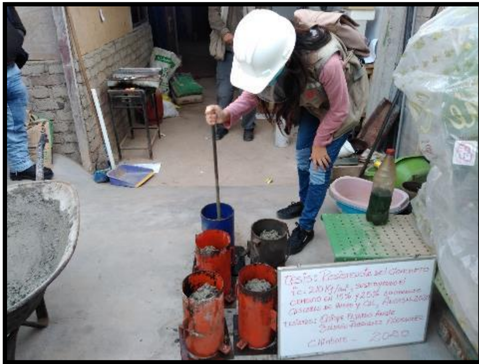
Fotografía 16. Realizando los 25 golpes en las tres capas del molde por cada probeta elaborada.
