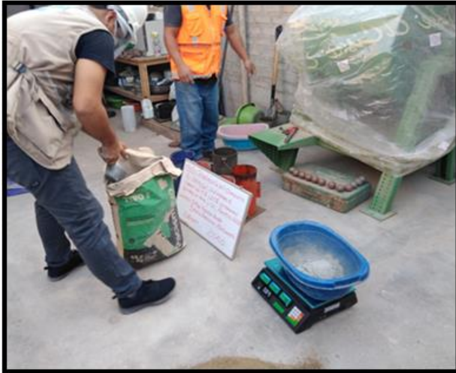
Fotografía 11. Realizando el peso del cemento para la mezcla de concreto.
