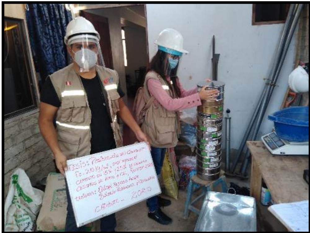
Fotografía 6. Realización del ensayo de granulometría.
