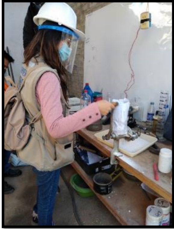
Fotografía 7. Molienda manual para las cáscaras de huevo.
