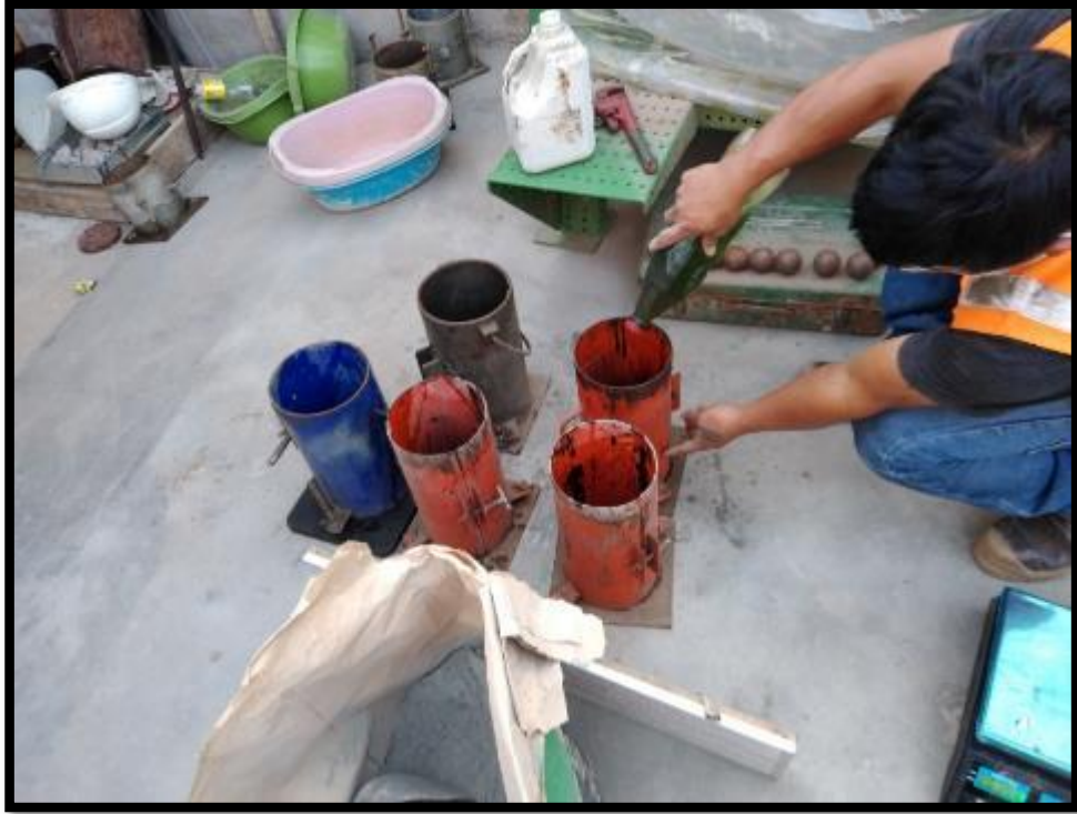
Fotografía 15. Echando petróleo a los moldes cilíndricos.
