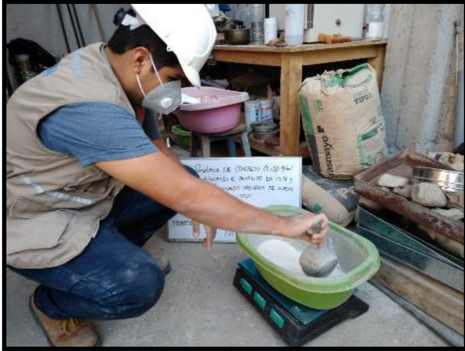
Fotografía 13. Realizando el peso del polvo de cáscaras de huevo para la mezcla de concreto.
