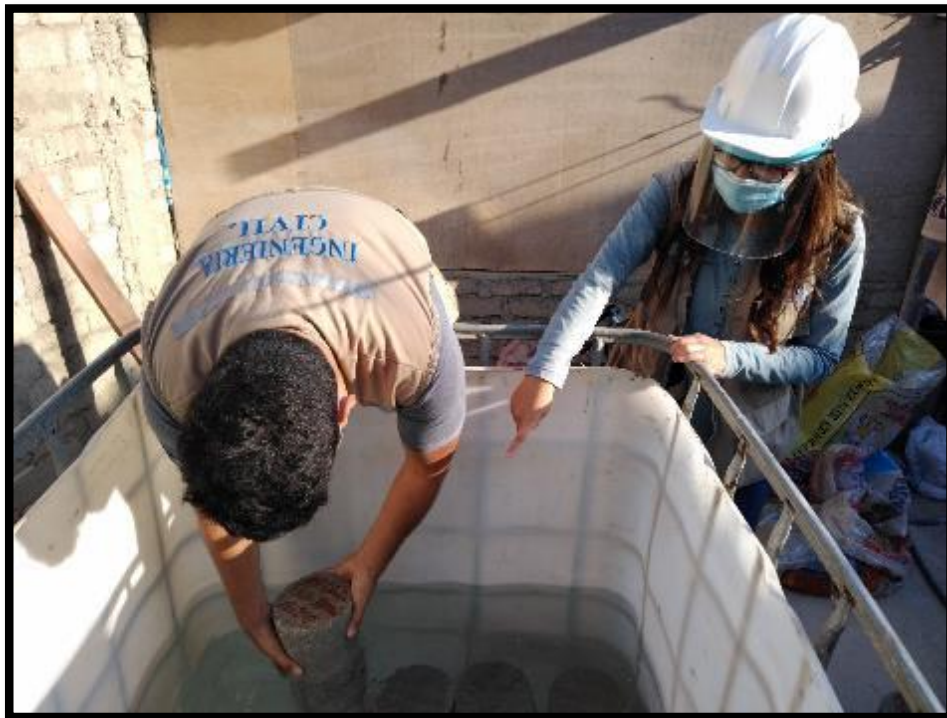
Fotografía 20. Colocación de las probetas en la piscina para su curado.
