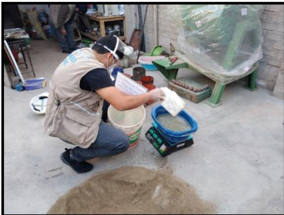
Fotografía 12. Realizando el peso del agua para la mezcla de concreto.
