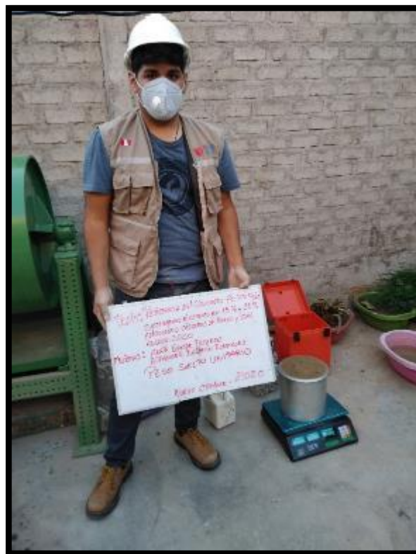
Fotografía 22. Ensayo de peso unitario y varillado de los agregados.
