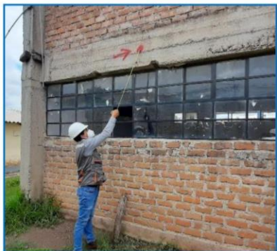
IMAGEN 07: Vistas de puntos para ensayos de Diamantina y Esclerómetro en columnas y vigas.
