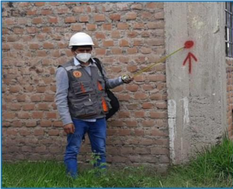
IMAGEN 13: Vistas de puntos para ensayos de Diamantina y Esclerómetro en columnas y vigas.
