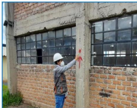
IMAGEN 07: Vistas de puntos para ensayos de Diamantina y Esclerómetro en columnas y vigas.
