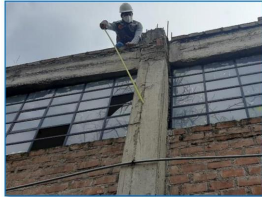
IMAGEN 13: Vistas de puntos para ensayos de Diamantina y Esclerómetro en columnas y vigas.
