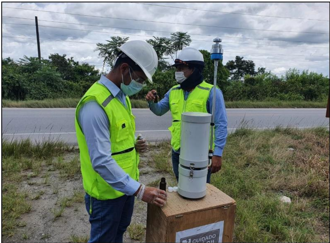
Foto N°10: Instalación de reactivos para NO
