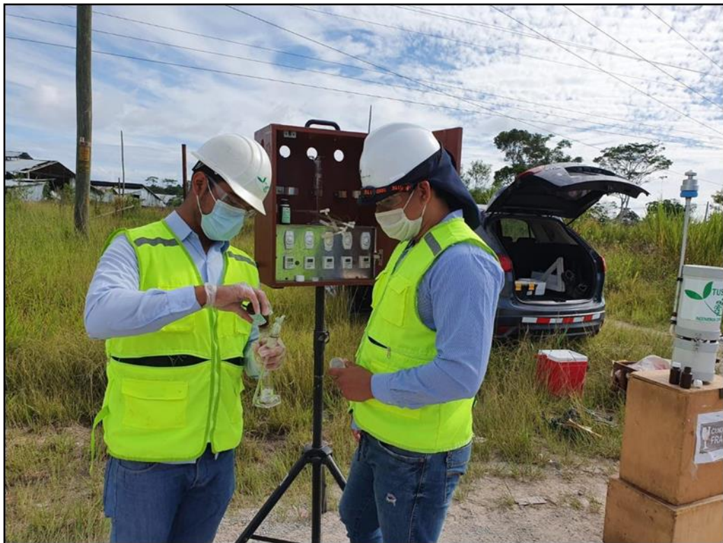
Foto N 06: Recolección de reactivos para \text{NO}_2
