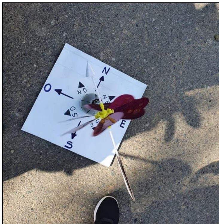
Foto N°02 Ejecución de la veleta artesanal
