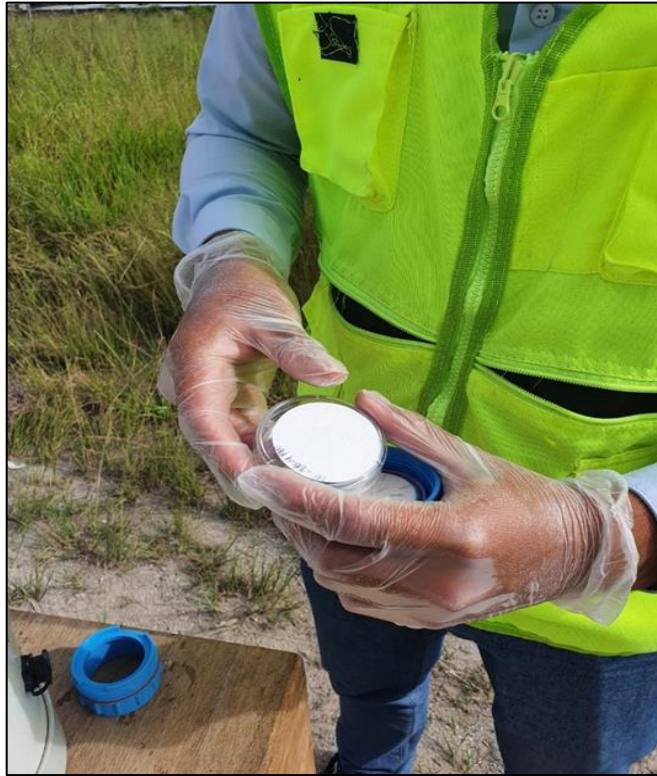
Foto N°11: filtro de teflón para PM_{10} de bajo volumen
