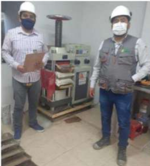
NTC 5 021 COMPRESION NO CONFINADA EN MUESTRAS DE SUELO.
