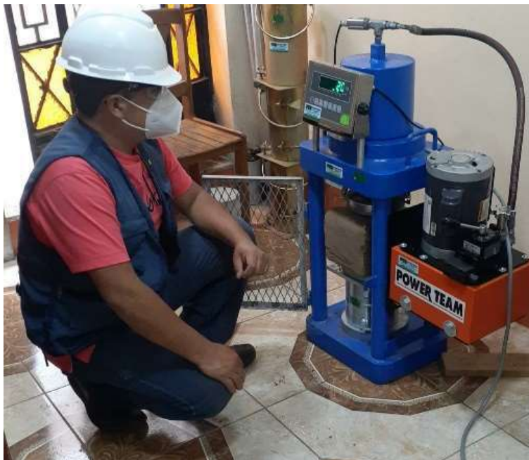
14.- Ensayo compresión adobe tradicional
