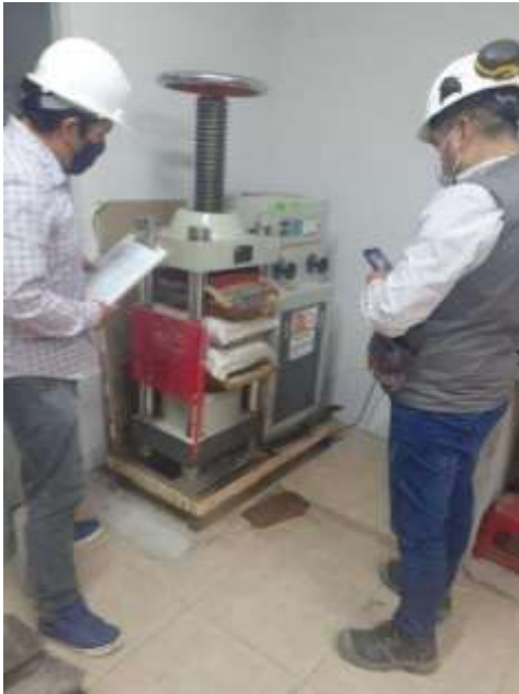
12.- Ensayo compresión Granular
