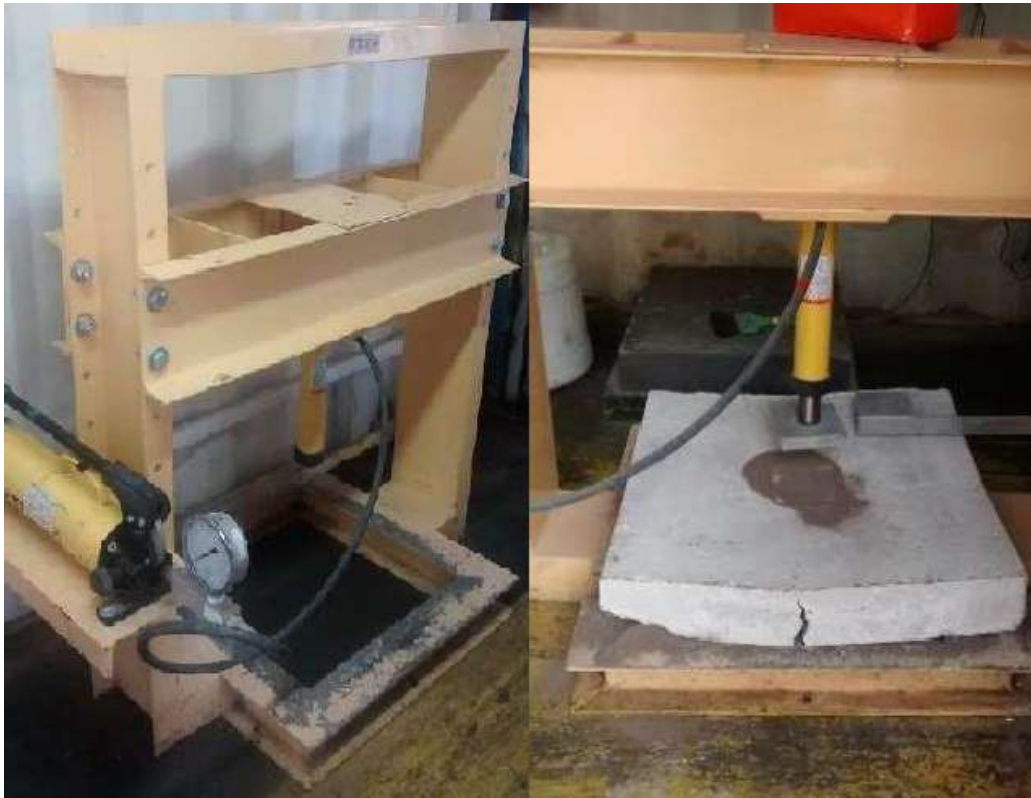
Figura 52. Ensayo a la absorción de energía Fuente. Laboratorio planta de concreto Andaychagua
