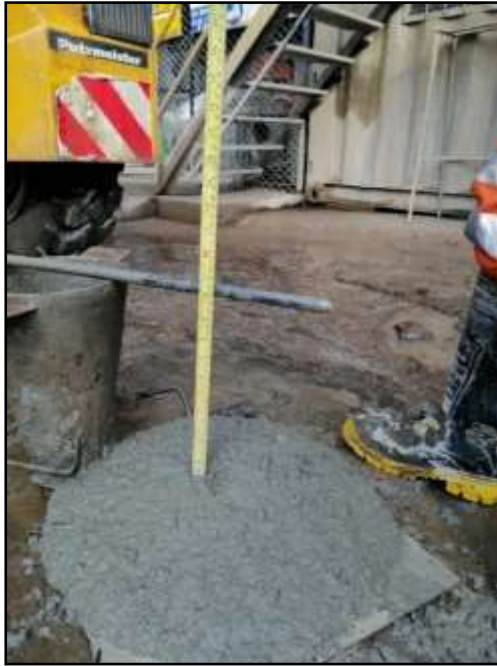
Figura 60. Prueba de slump 10 ½" en superficie Fuente. Elaboración propia.
