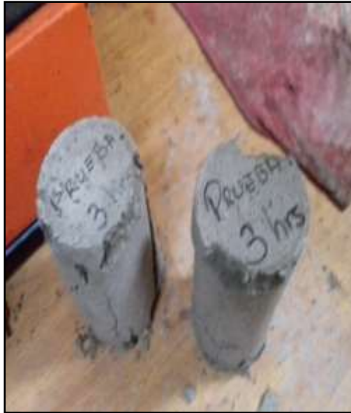
Figura 30. Testigos diamantinos de shotcrete
