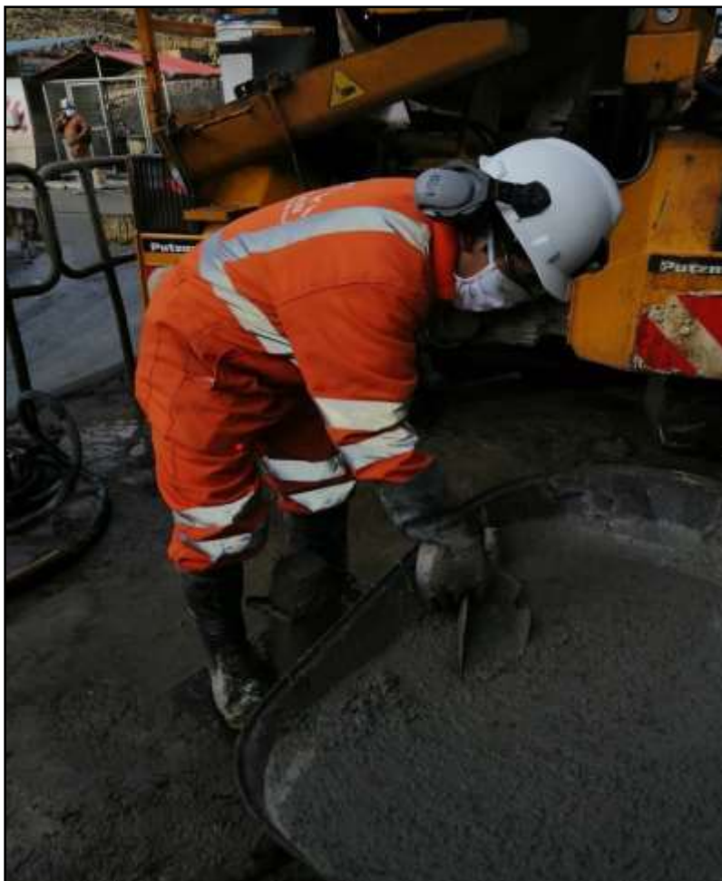
Figura 59. Prueba de slump en superficie
