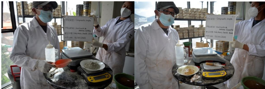
Figura N°5 Dosificación de SOLIDRY y CONSOLID
