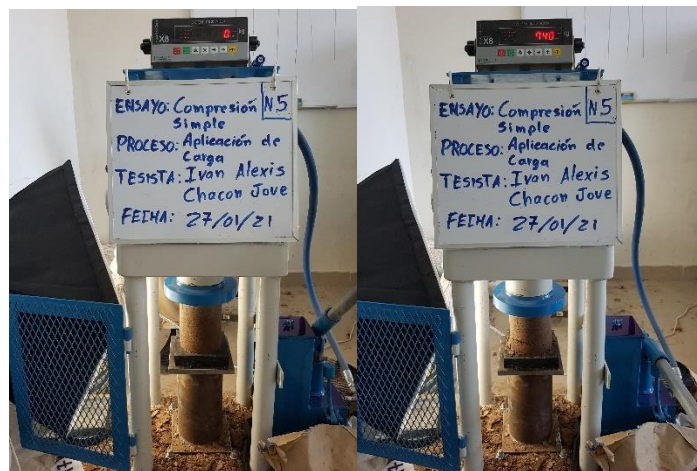
Figura N°9 Prueba de Compresión Simple
