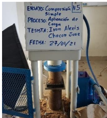
Figura N°12 Ensayo de Compresión Simple
