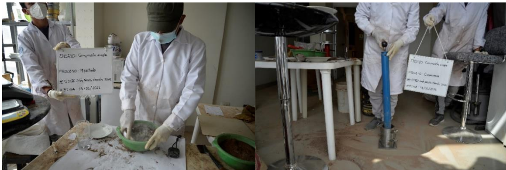
Figura N°6 Mezclado y Compactado
