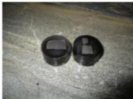
Figura 9. Probetas obtenidas de las mandíbulas de chancadoras Jaques
