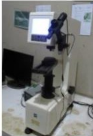
Figura 1. Durómetro digital universal TIME GROUP – 187.5. Escala Brinell (HB)
