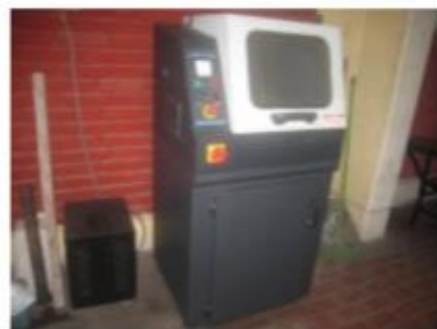
Figura 10. Máquina de BAINCUT – M para el corte de probetas
