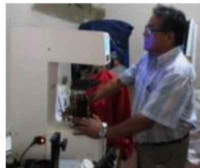
Figura 4. Medición de dureza en el durómetro TIME GROUP – 187.5 en la escala Brinell (HB)
