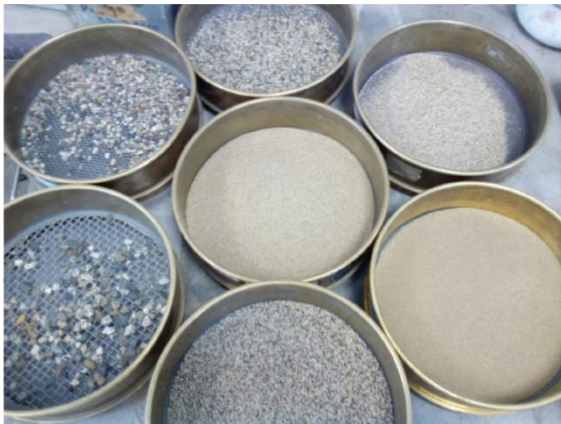
Figura 39 Ensayos de Análisis granulométrico (ASTM C -136).
