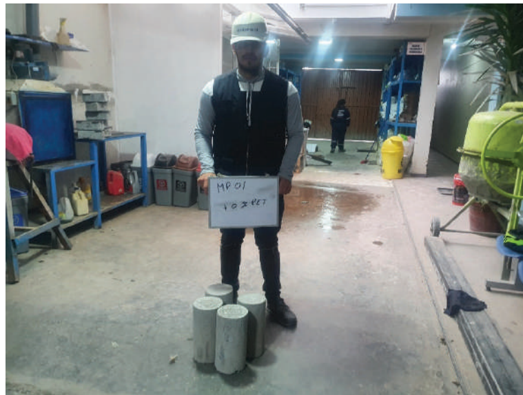
Figura 43 Testigos con concreto estándar a los 14 días de edad.
