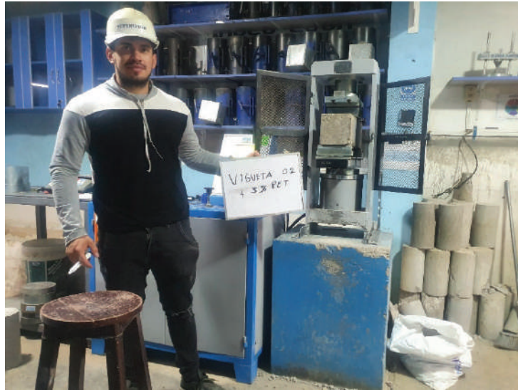
Figura 50 Ensayo a flexión de un concreto reforzado con fibras en un 5%.
