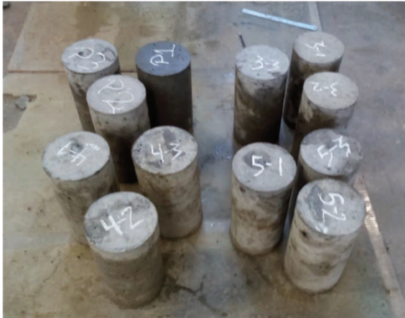
Figura 42 Testigos luego de 28 días de curado.
