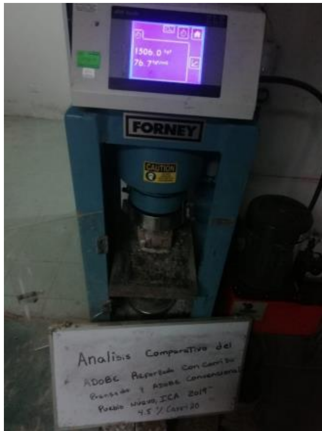
Fotografía 4: Ensayo de compresión adobe con 4.5% de carrizo prensado
