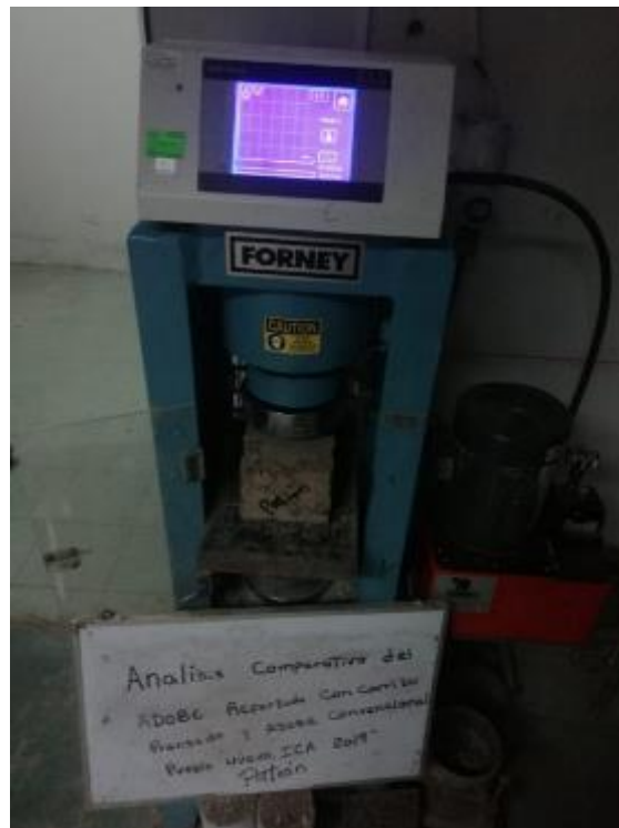
Fotografía 6: Ensayo de flexión adobe patrón
