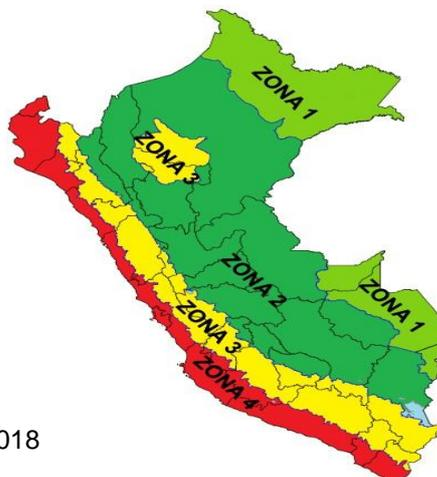
Figura 28. Zonas sísmicas. Fuente: NTP E.030 – 2018
