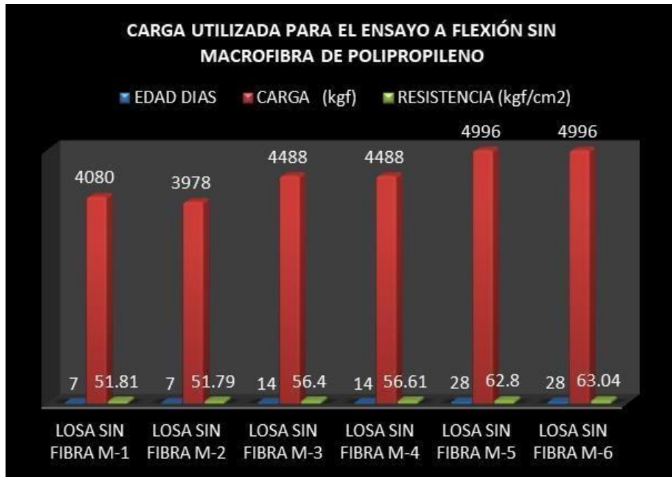
GRÁFICA N° 3 : RESISTENCIA OBTENIDA DEL ENSAYO A FLEXIÓN SIN MACROFIBRA DE POLIPROPOILENO
