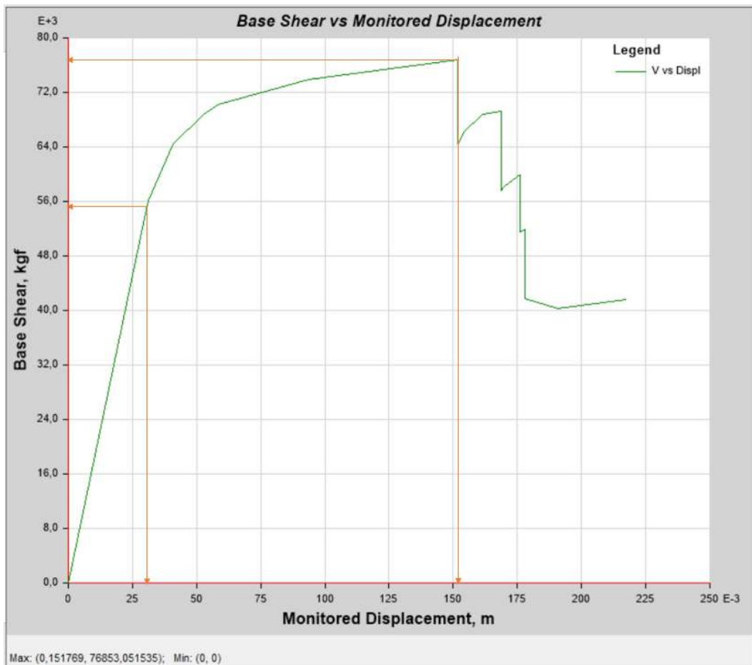
Figura 34. Fuerza cortante vs desplazamiento en el eje Y
