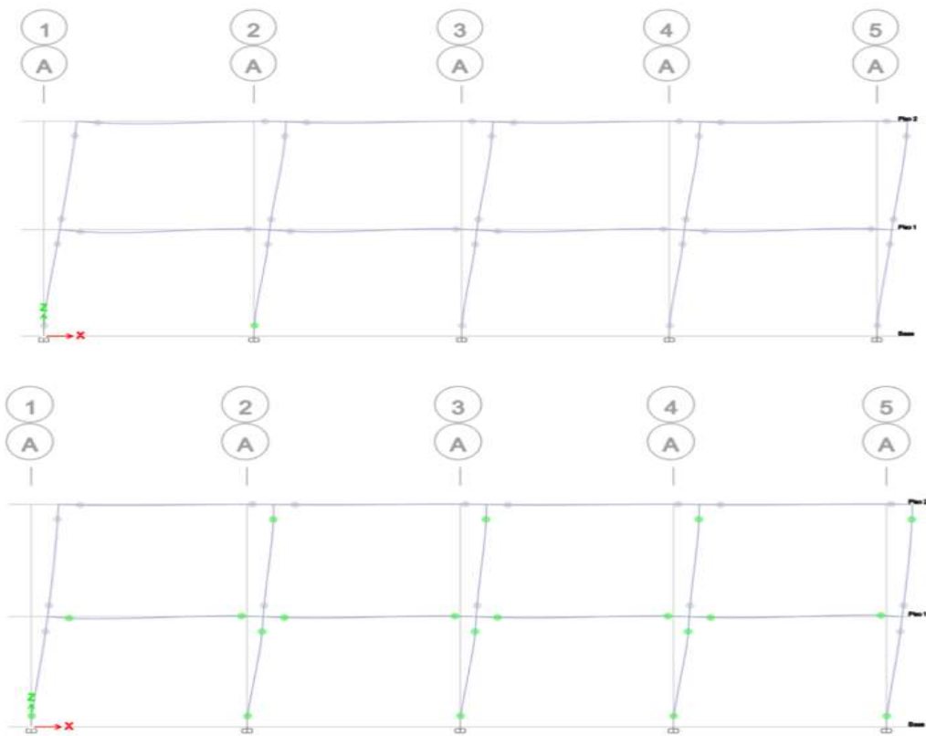
Figura 32. Vista de rotulas plásticas cuando aparecen en la estructura
