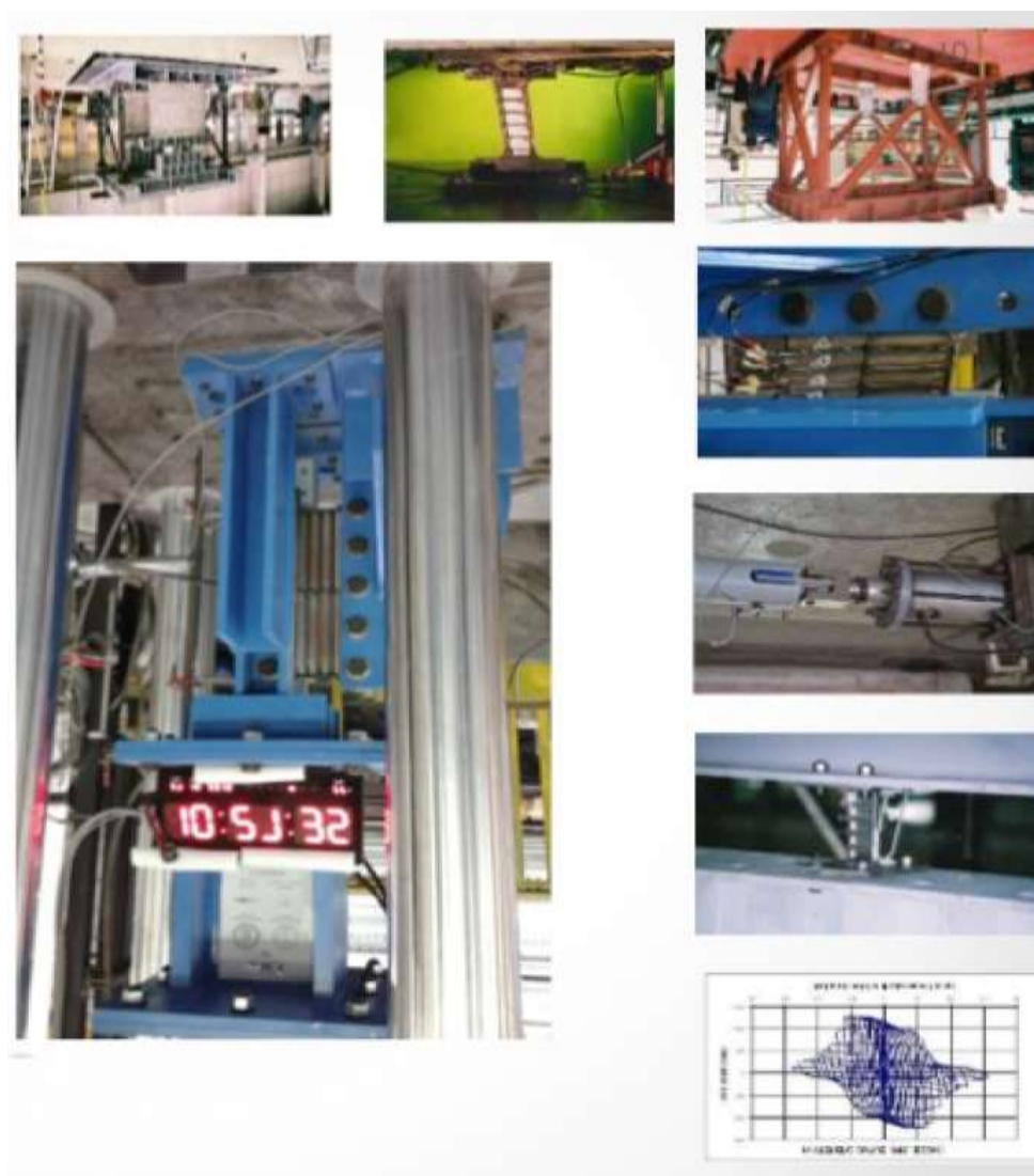
Figura 42. Ensayos de los dispositivos SLB, curva histeretica.
