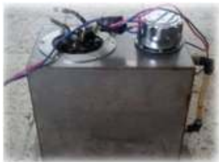
Figura 11. Tanque portátil de combustible.
