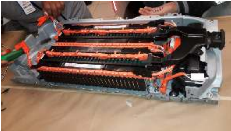
Figura 14. Batería híbrida del vehículo híbrido 220 volt
