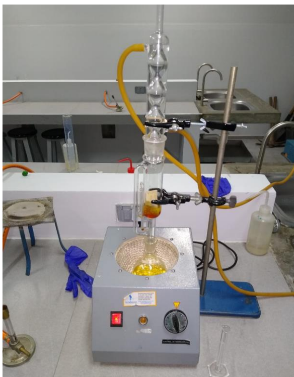
Figura 9. Extracción por Método Soxhlet
