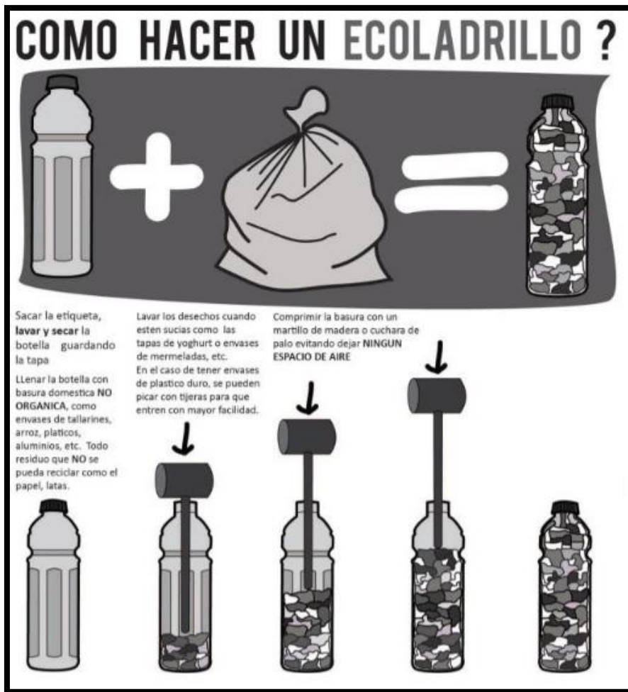
Figura 11: Eco-ladrillo elaboración
