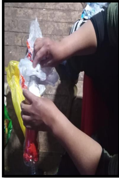
Figura 33: Proceso en el que se introduce la bolsa de plástico dentro de las botellas de PET.
