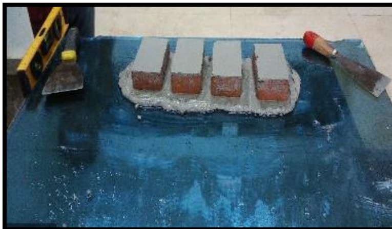
Figura 23: Ladrillos con capping de yeso
