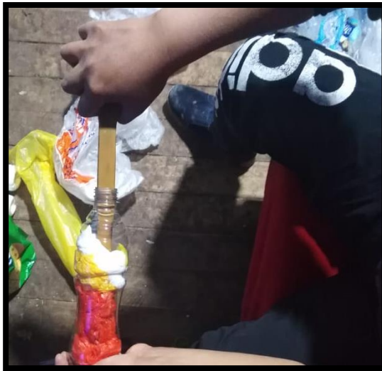
Figura 30: Varilla de madera para su compactación
