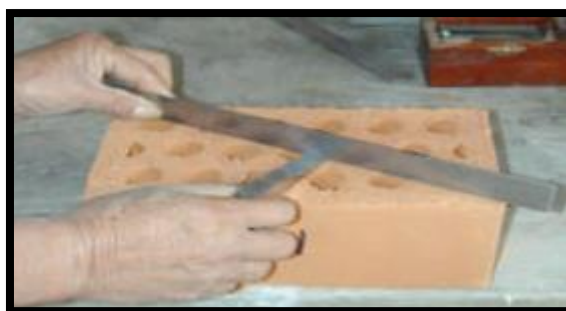
Figura 16: Alabeo a la unidad de albañilería (ladrillo)
