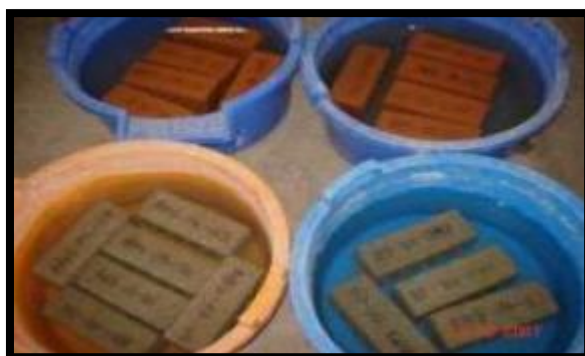
Figura 21: Medida de la absorción de una unidad de Albañilería
