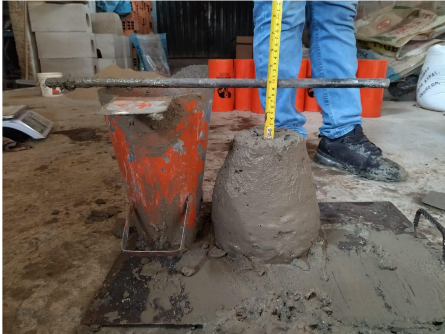
Foto N° 23: Comprobando que el asentamiento dé 3.5" a 4", por ser considerado trabajable, para así poder ser apto para el diseño.
