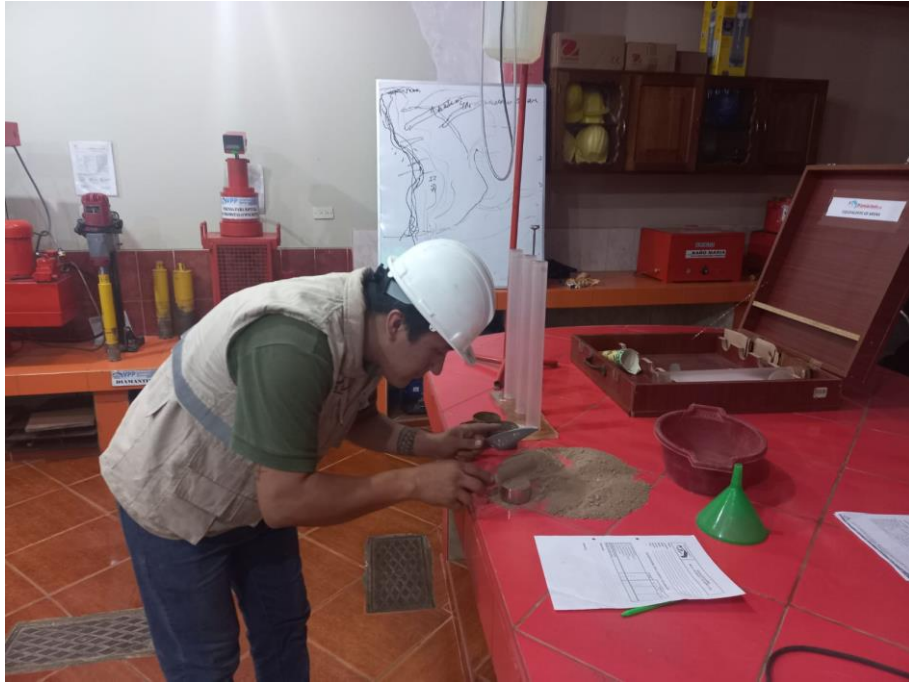
Foto N° 15: Ensayo de equivalente de arena.
