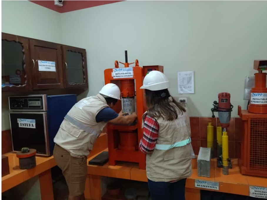
Foto N° 35: Autores colocando la probeta en la prensa para la rotura.
