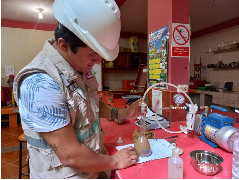
Foto N° 19: Ensayo de peso específico al agregado fino.
