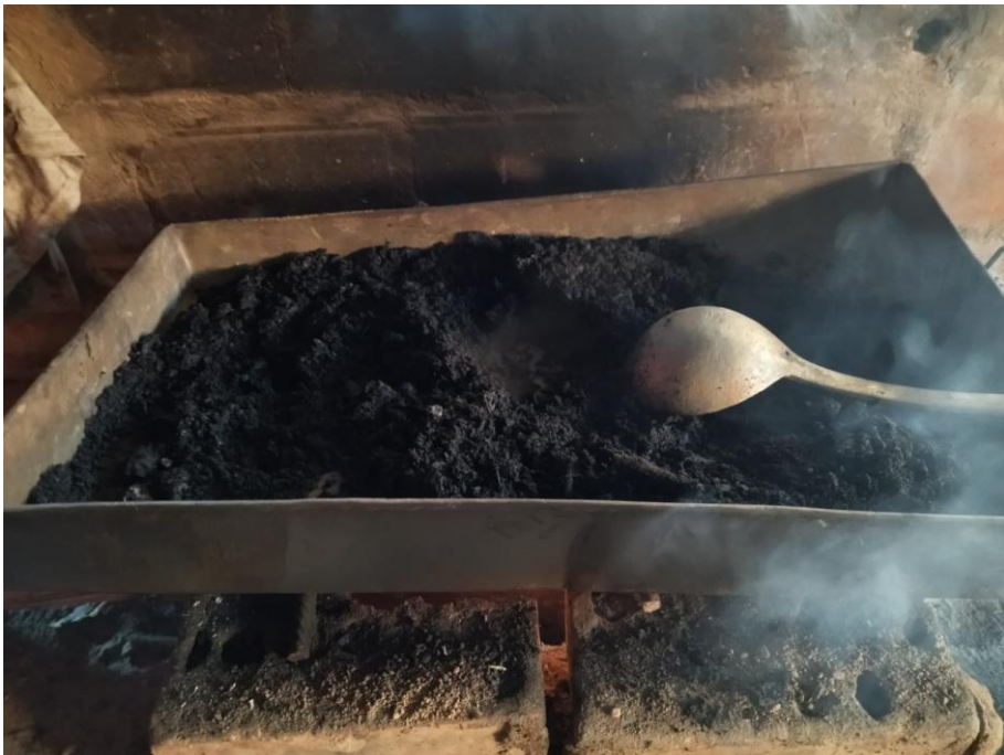
Foto N° 28: Secado de la ceniza de bagazo de caña de azúcar.
