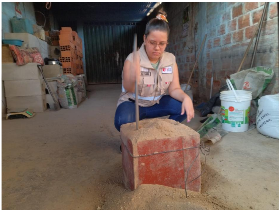
Foto N° 10: Ensayo de peso unitario varillado del agregado fino.
