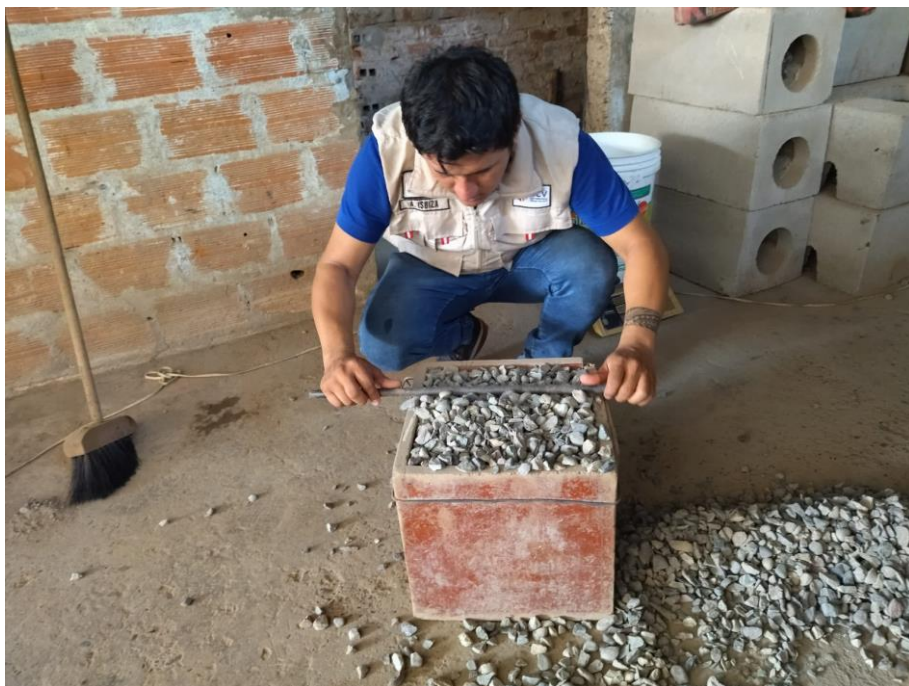
Foto N° 12: Enrasando del material grueso para el ensayo de peso unitario.
