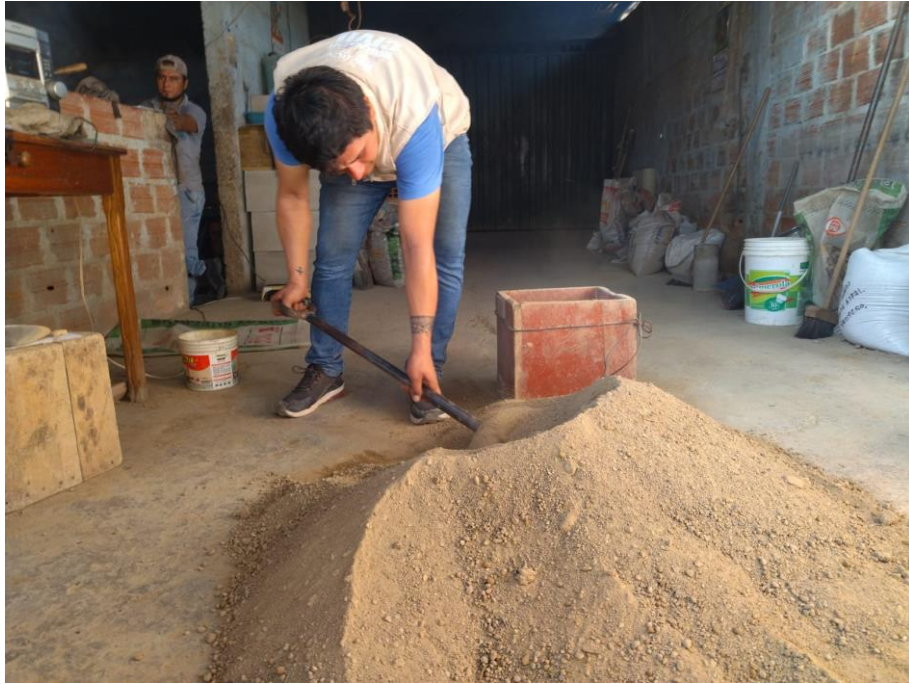
Foto N° 09: Ensayo de peso unitario suelto del agregado fino.
