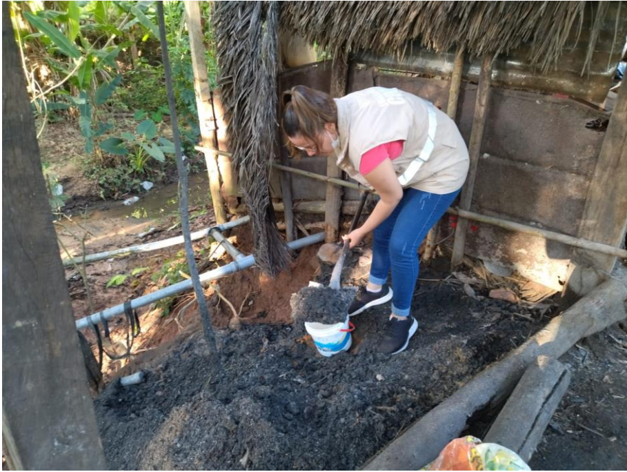
Foto N° 27: Extracción de la ceniza del bagazo de caña de azúcar.
