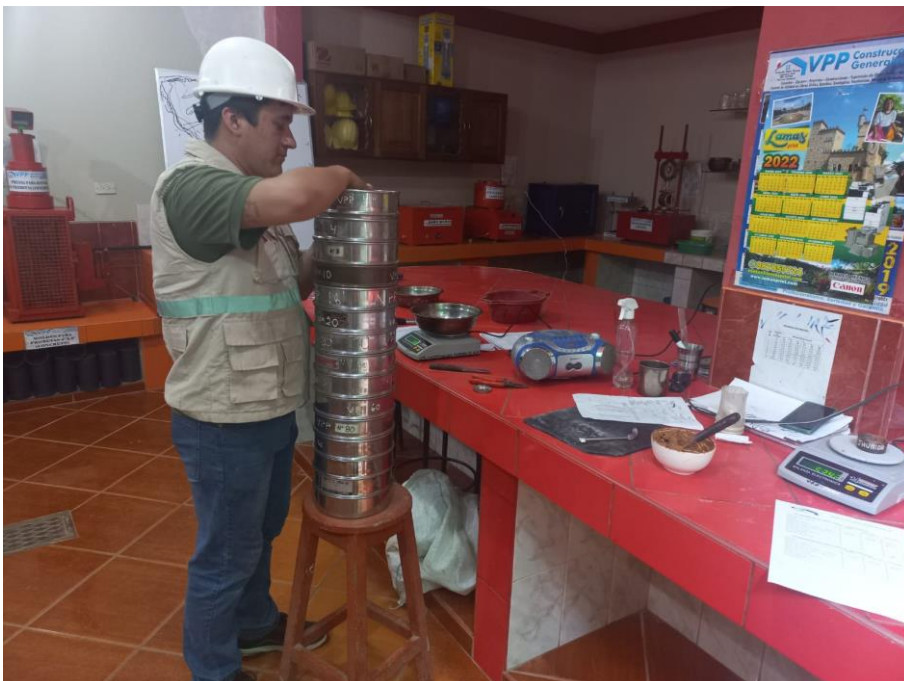
Foto N° 14: Ensayo de granulometría por parte del autor.
