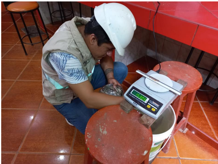
Foto N° 20: Ensayo de peso específico al agregado grueso.
