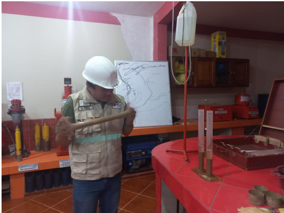
Foto N° 16: Autor realizando ensayo de equivalente de arena.
