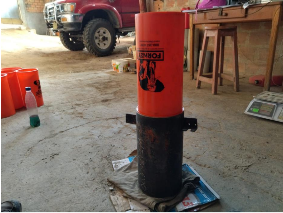
Foto N° 31: Desmolde de testigos.
