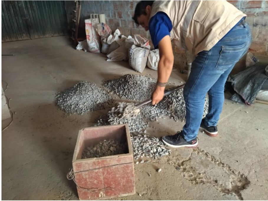
Foto N° 11: Introducción de material para realizar ensayo de peso unitario de la piedra chancada.
