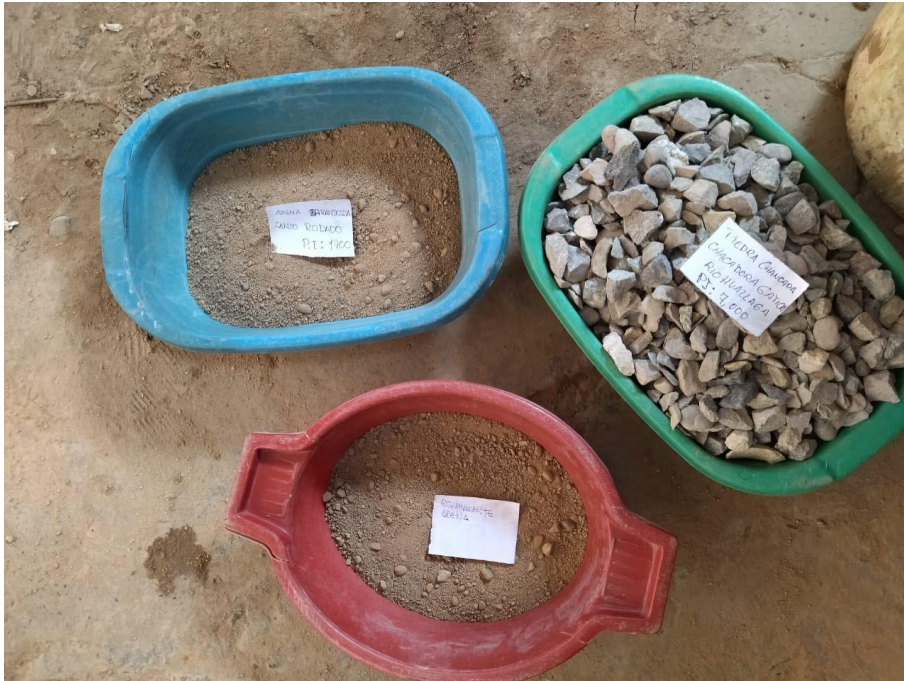
Foto N° 13: Material para realizar ensayo de peso específico, granulometría y equivalente de arena.
