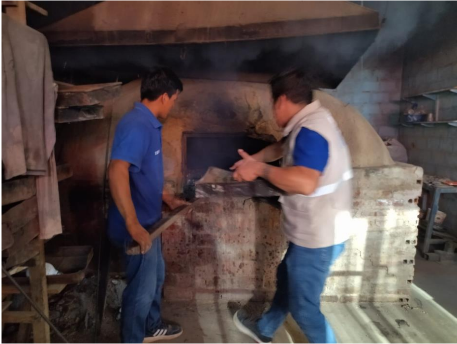
Foto N° 07: Introducción en el horno de las bandejas conteniendo arena para su secado.
