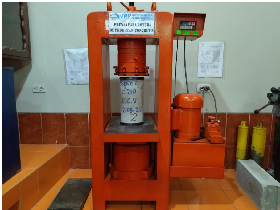
Foto N° 36: Probeta en la prensa para rotura.
