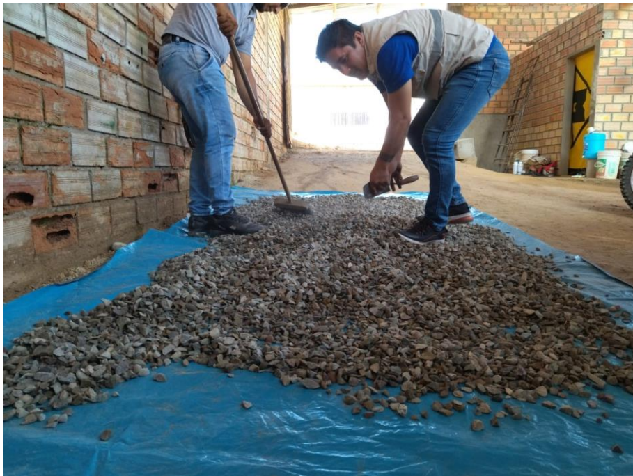
Foto N° 04: Secado de la piedra chancada con apoyo del autor.
