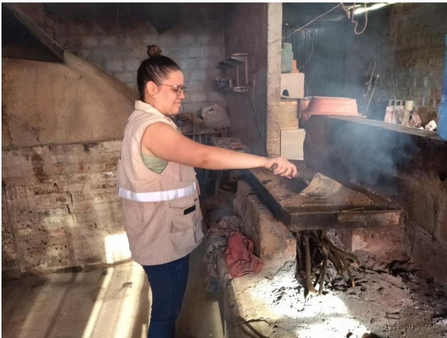
Foto N° 08: Secado de arena de manera manual.
