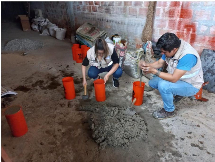
Foto N° 24: Proceso de moldeado de los testigos
