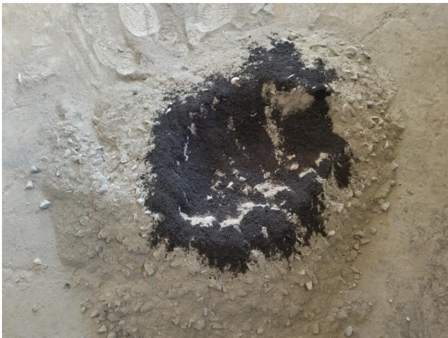
Foto N° 30: Mezcla de ceniza de caña de azúcar, agregado fino y grueso.
