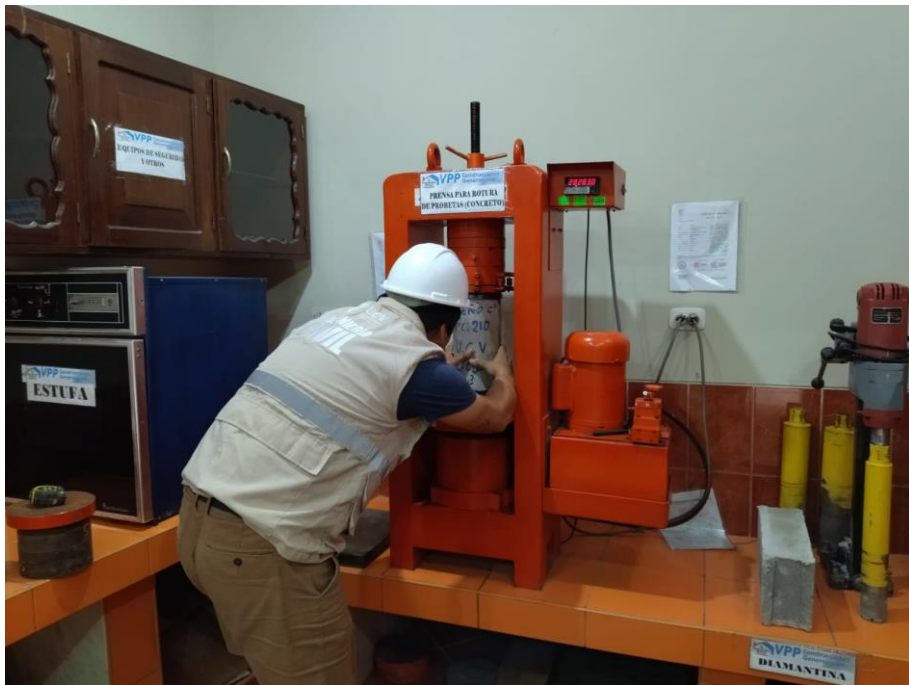
Foto N° 34: Autor colocando la probeta en la prensa para la rotura.
