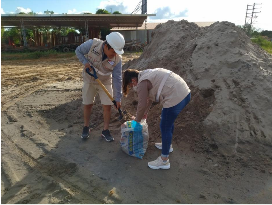
Foto N° 01: Extracción de material fino por parte de los autores.
