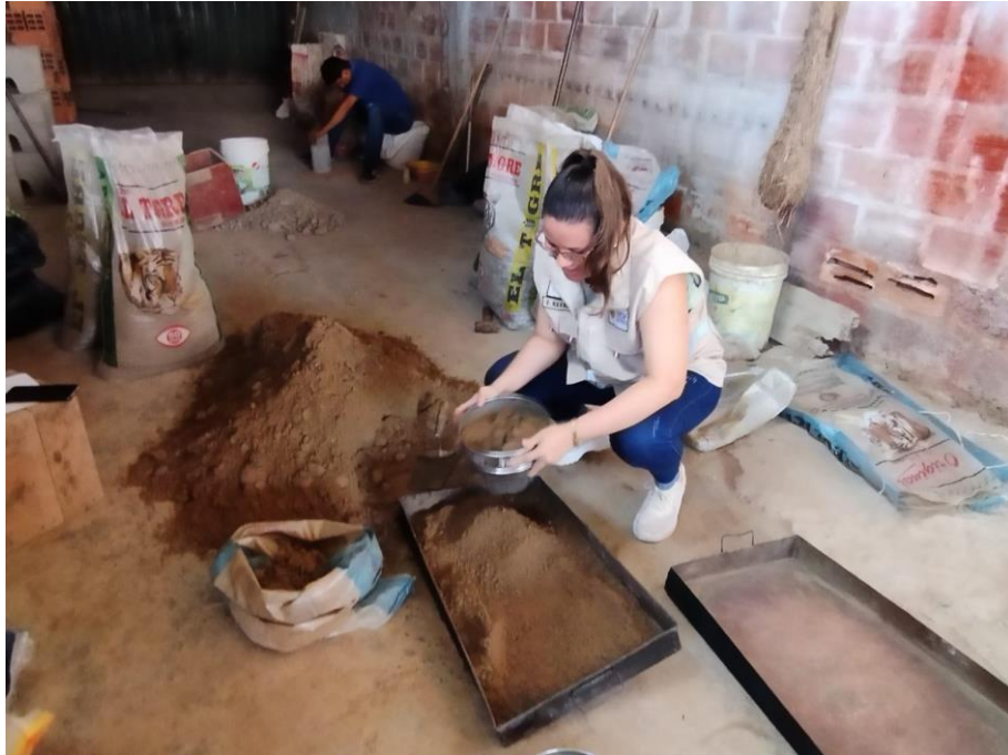
Foto N° 05: Proceso de zarandear la arena por la malla N° 08.
