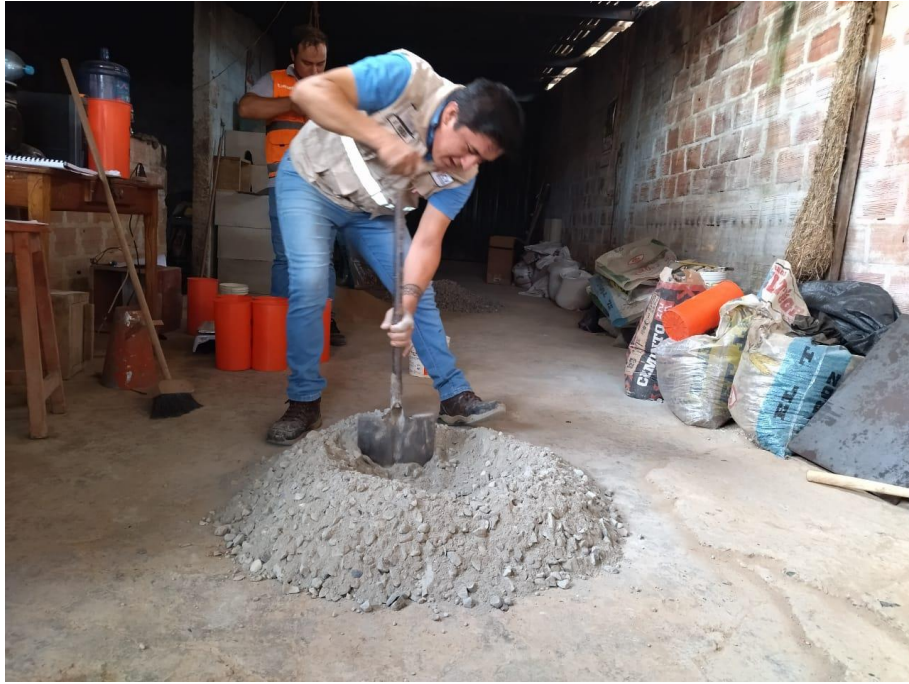
Foto N° 21: Proceso de realizar la mezcla para las probetas.
