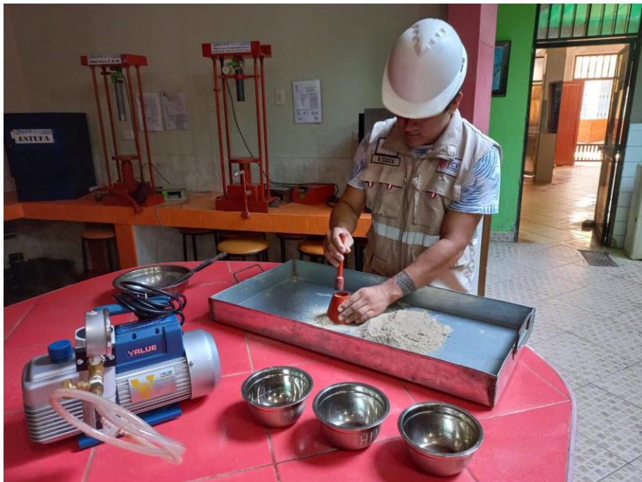
Foto N° 18: Autor realizando prueba de cono de Abrams para verificar si el agregado fino se encuentra seco superficialmente para posteriormente realizar el ensayo de peso específico.
