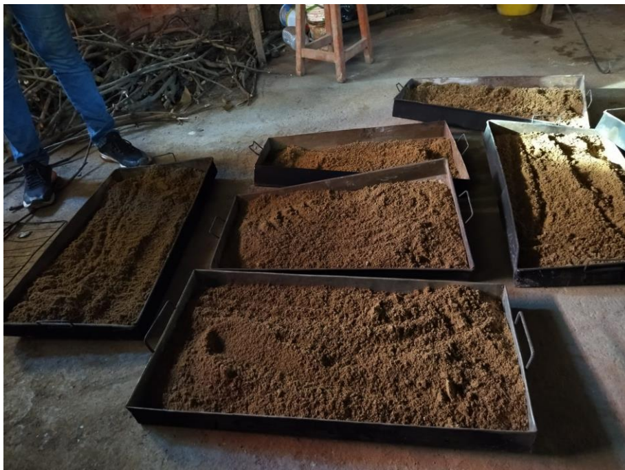
Foto N° 06: Arena zarandeada colocada en bandejas para su proceso de secado en el horno
