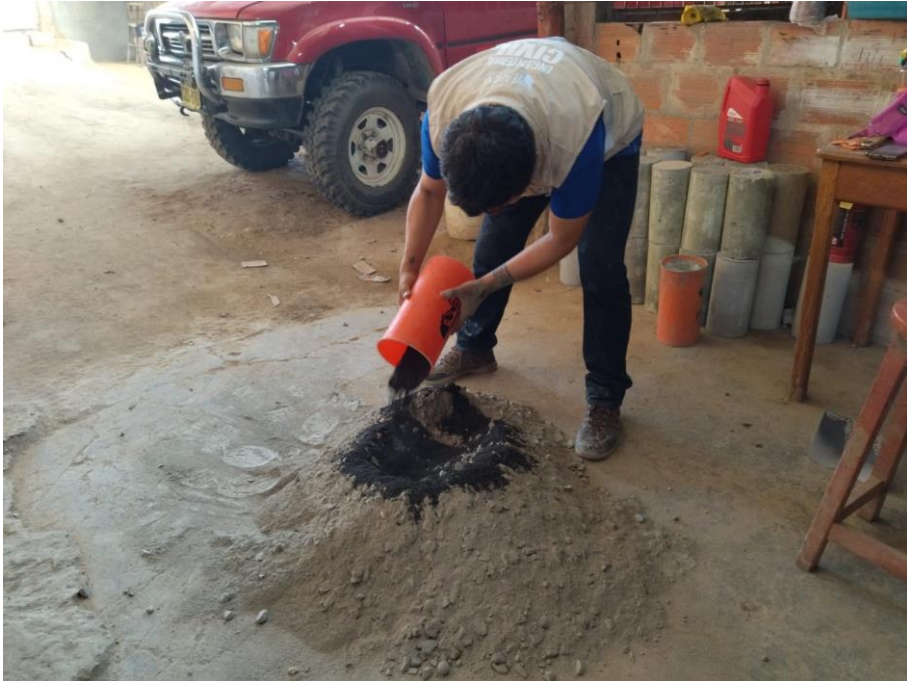
Foto N° 29: Incorporación de la ceniza de caña de azúcar al agregado fino y grueso.
