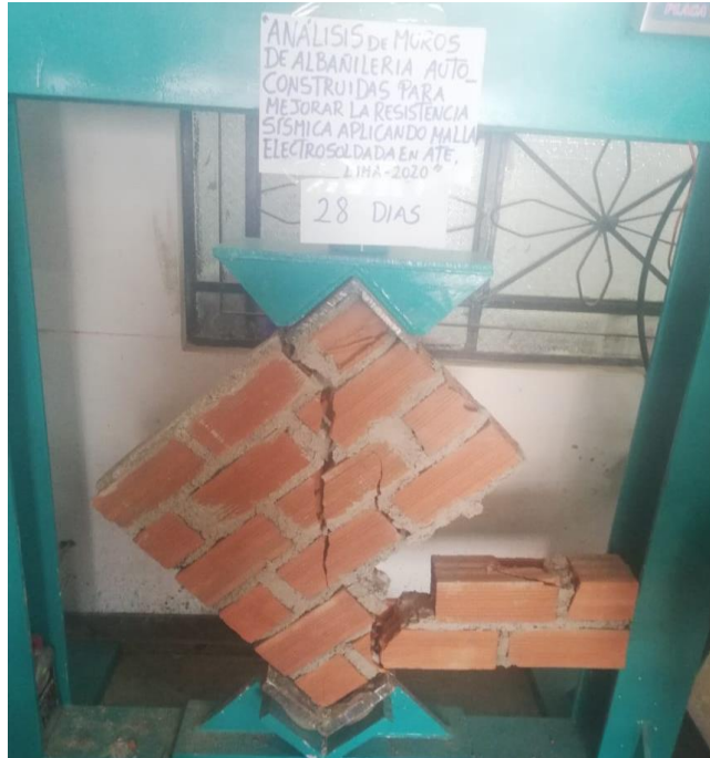
Figura 26: Falla de corte diagonal en murete sin refuerzo presentada con una grieta de 20mm.
