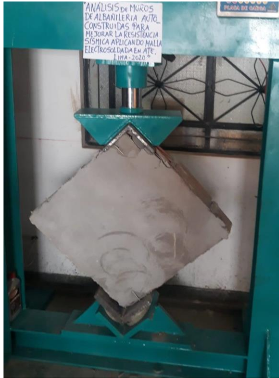
Figura 10: Ensayos de compresión diagonal con murete
