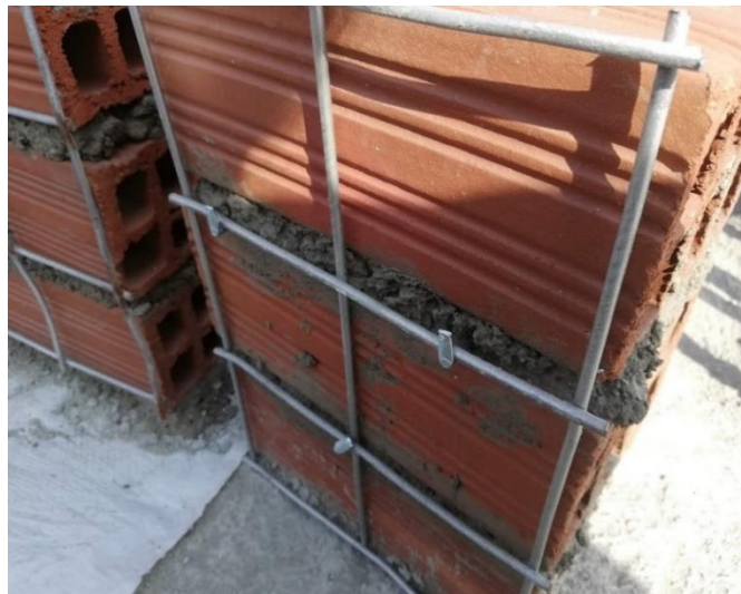
Figura 23: Pila de ladrillo pandereta reforzado con malla electrosoldada Fuente: Elaboración propia
