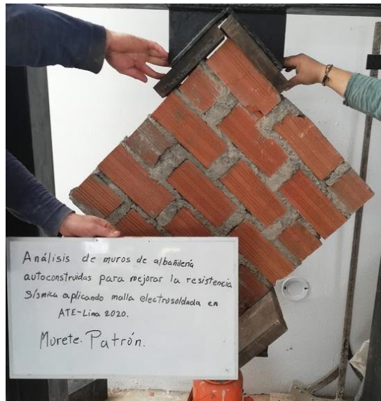
Figura 24: Murete de 60x60 con ladrillo pandereta sin refuerzo
