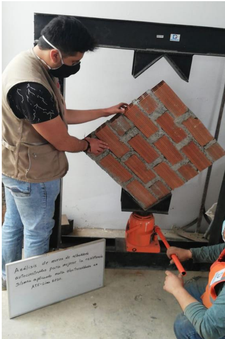
Figura 38: Colocación del espécimen del murete a la prensa sin refuerzo.
