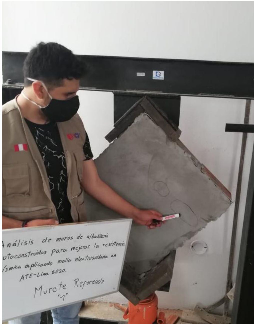
Figura 43: Murete presenta falla por deslizamiento presentando pequeñas fisuras horizontales de 0.90mm.
