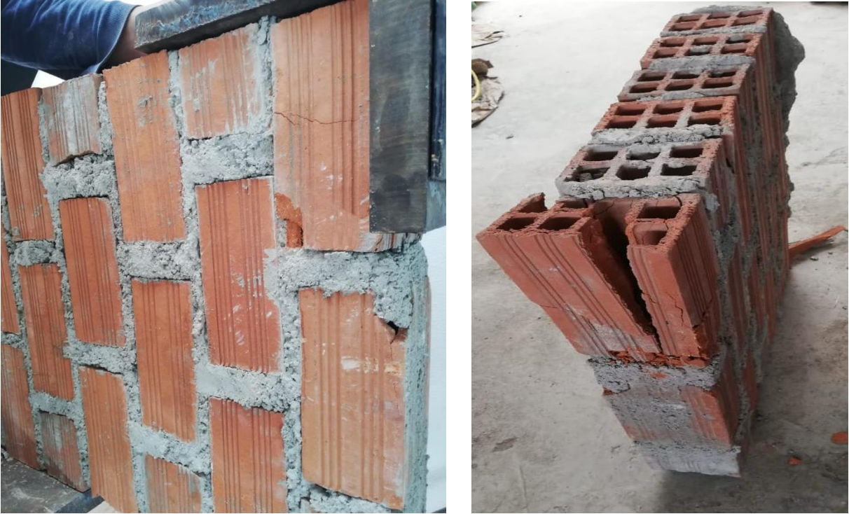
Figura 39: Murete presenta falla a flexión por el pandeo en el talón.
