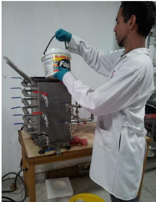
Figura 16. Vertimiento del agua al equipo de nanoburbujeo
