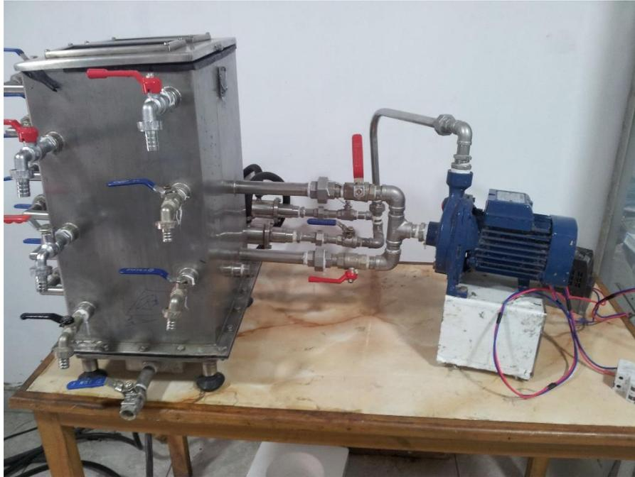
Figura 6. Equipo de nano burbujeo
