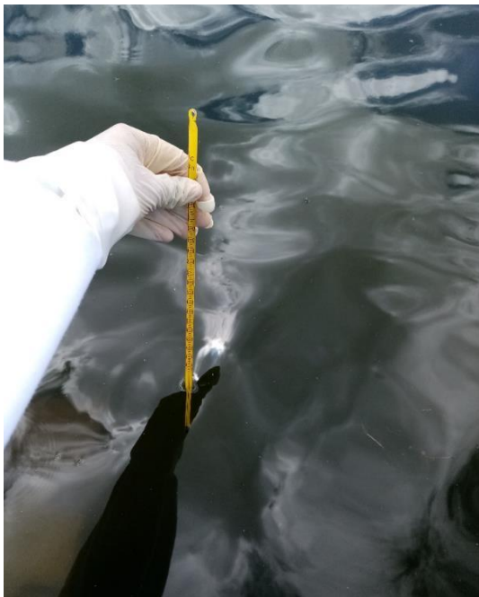
Foto N° 03: toma de temperatura in situ.
