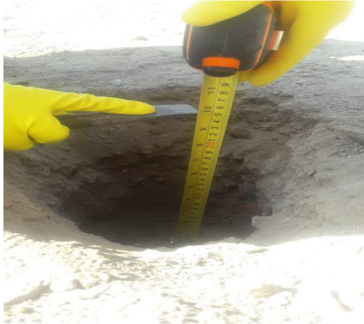
Figura 20. Medición de profundidad y de toma de muestras de (2 kg) cada una.
